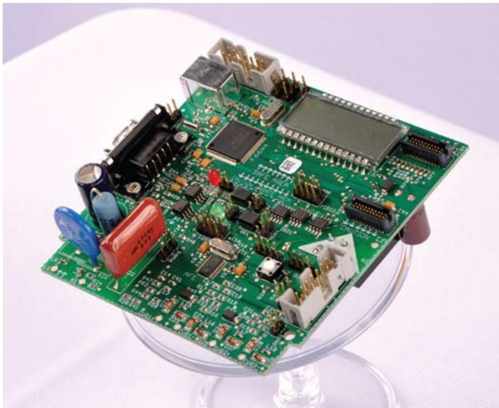
Рис. 6. Прототип однофазного электросчетчика на базе MSP430AFE253
