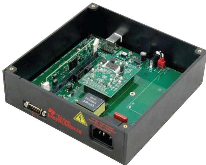
Рис. 5. PLC-модем из набора TMDSPCKIT-V3
