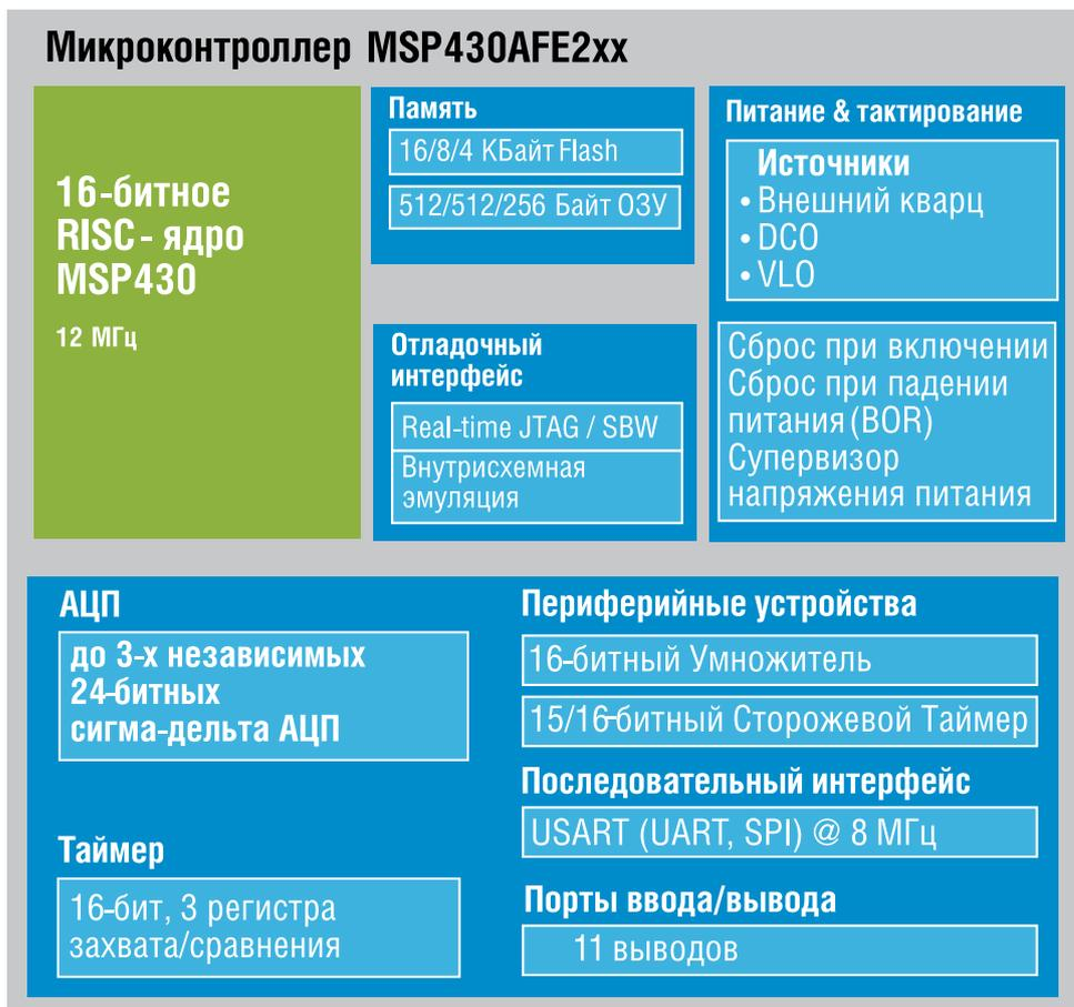
Рис. 2. Блок-схема микроконтроллеров MSP430AFE2xx
