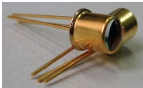
Рис. 2. ИК-приемник SD5443-003 на базе кремниевого фототранзистора
