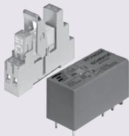
Миниатюрные электромеханические реле семейства **RT** компании **TE Connectivity** для монтажа на печатную плату нашли широкое применение в устройствах автоматизации, телеметрии, интерфейсных и исполнительных модулях. С помощью дополнительных аксессуаров они могут крепиться на DIN-рейку в системах промышленной автоматизации. Реле выпускаются в герметичном и брызгозащитном исполнении. Рабочий температурный диапазон реле **-40...85°C**.
