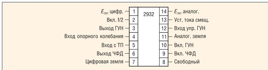
Рис. 11. Нумерация выводов микросхемы TLC2932
