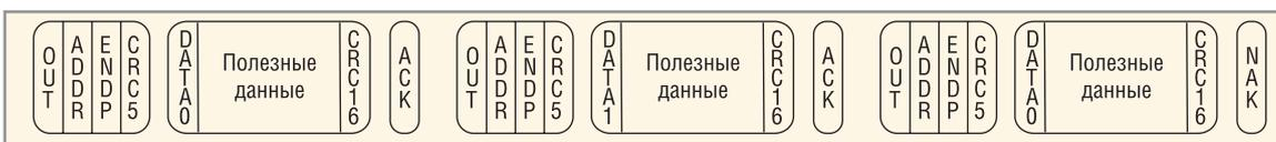
Рис. 6. BULK передача данных
