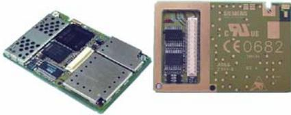
Рис. 3. GSM/GPRS/GPS-совмещённый OEM-модуль XF55-AVL
