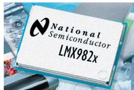
Рис. 5. Общий вид Bluetooth-модуля LMX9820S
