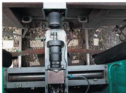
Рис. 4. Фотография оптико-механического блока габаритомера
