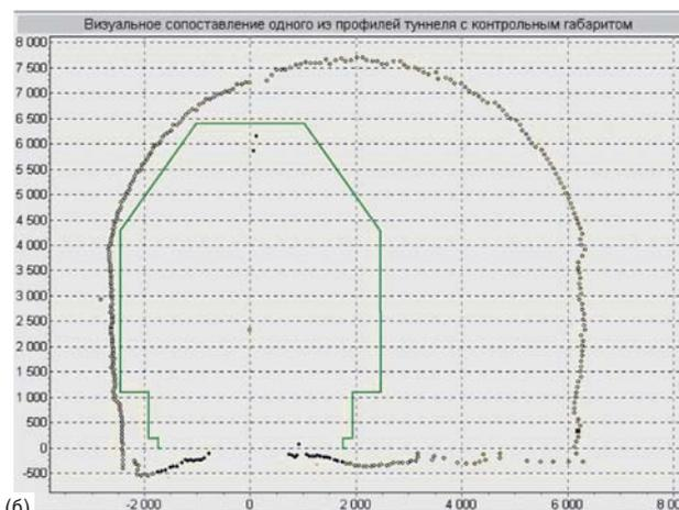
Рис. 6. (а) Трёхмерное представление туннеля; (б) одно из сечений туннеля
