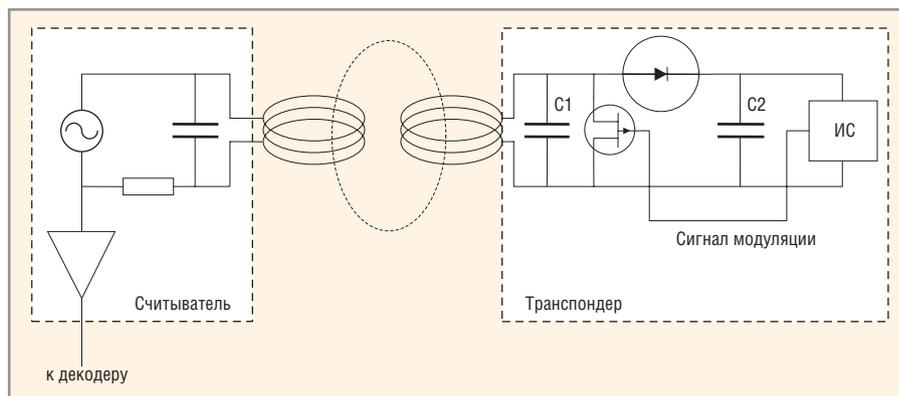
Рис. 4. Схема системы с пассивным мультибитным транспондером
