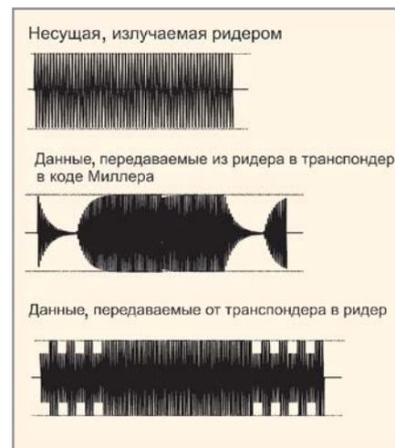
Рис. 14. Виды модуляции, применяемые в mifare-системах
