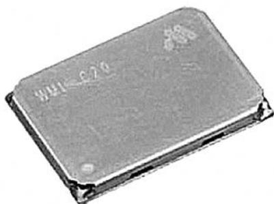
Рис. 2. Общий вид Bluetooth-модуля WML-C20H
