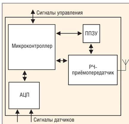
Рис. 1. Структурная схема системы сбора данных с радиоканалом
