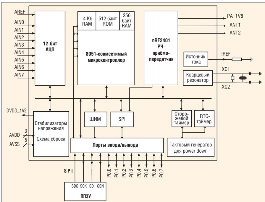
Рис. 3. Структурная схема nRF24E1
