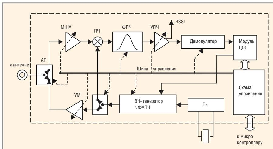
Структурная схема типичного однокристалльного RF-трансивера диапазона частот 300...1000 МГц
