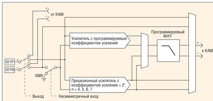
Рис. 2. Структура конфигурируемой ячейки
