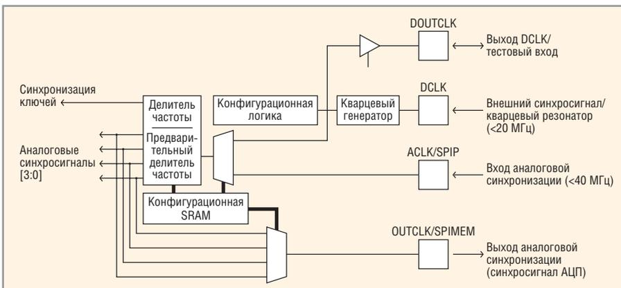
Рис. 5. Структурная схема системных тактовых и функциональных генераторов
