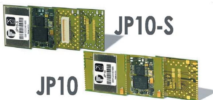
Рис. 2. Высокочувствительные 20-канальные GPS-приёмники JP-10, JP-10S
