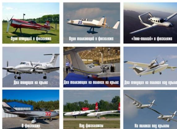
Рисунок 3. Классификация самолетов по расположению двигателей
