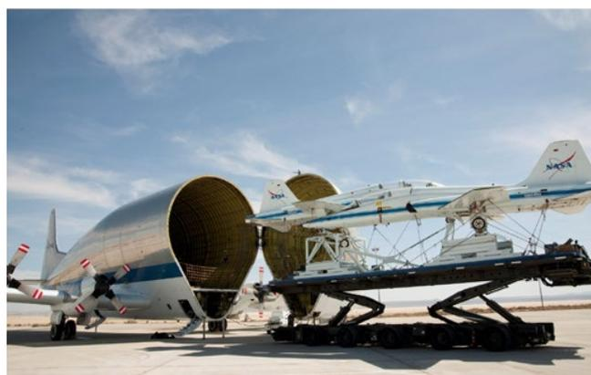
Рисунок 22. Транспортный самолет Aero Spacelines Super Guppy для перевозки негабаритных грузов (форма фюзеляжа определена габаритами груза)
