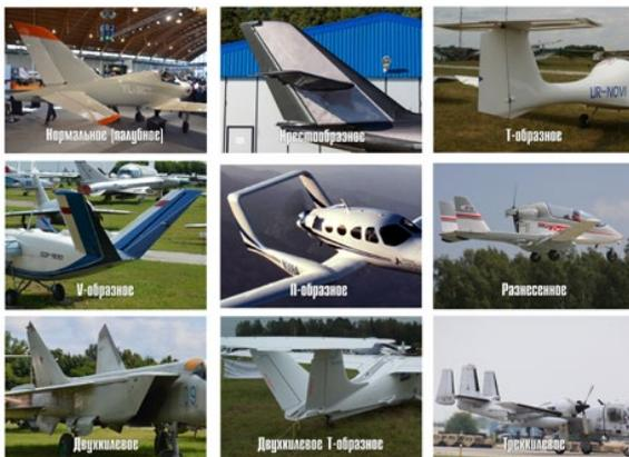
Рисунок 25. Различные виды оперения самолетов
