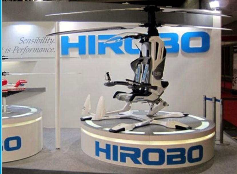
Японская компания Hirobo Electric Corporation планирует выпустить первый в мире электрический пилотируемый одноместный вертолет Hirobo BIT на рынок уже в 2017 году. Силовой установкой вертолета является электродвигатель, который питается от аккумулятора. Одной зарядки аккумулятора хватит на 30 минут полета, и вертолет способен преодолеть за это время 90 км. Цена вертолета ожидается на уровне 240 тысяч долларов.
