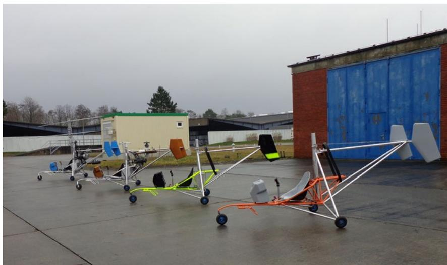
Четыре предсерийных прототипа вертолета VR115 уже изготовлены
