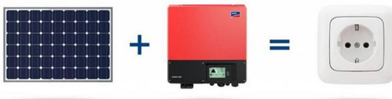
Схема солнечной электростанции без аккумуляторов [12]
