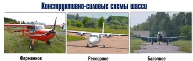
Рисунок 29. Основные конструктивно-силовые схемы шасси
