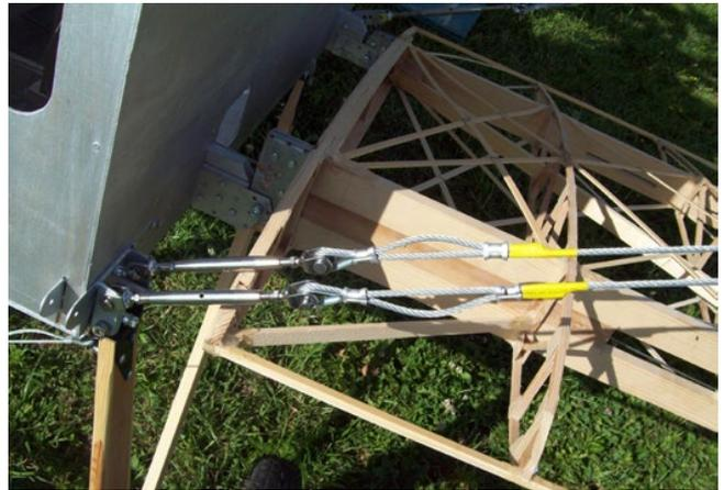
Узел крепления деревянной бипланной коробки крыльев
