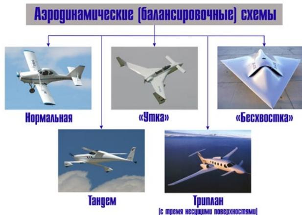
Рисунок 1. Классификация самолетов по расположению крыла и оперения
