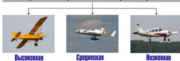
Рисунок 2. Классификация самолетов по расположению крыла и фюзеляжа
