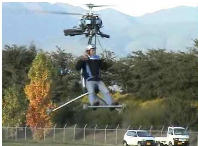
Испытания прототипа одноместного вертолета Hirobo BIT
