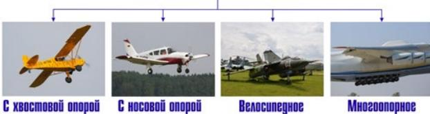
Рисунок 5. Классификация шасси по расположению опор
