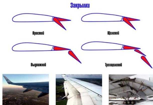
Рисунок 16. Закрылки самолета: 1) простой; 2) щелевой; 3) выдвижной; 4) многощелевой
