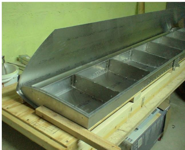
Рисунок 7. Металлическая обшивка крыла самолета Zodiac CH-601
