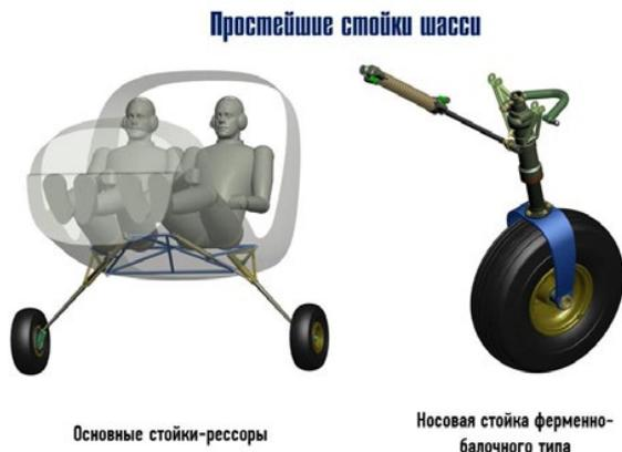
Рисунок 30. Простейшая стойка шасси
