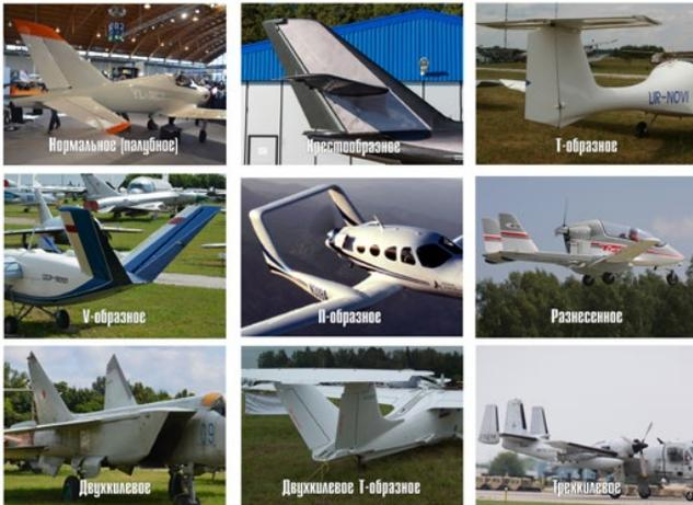
Рисунок 4. Классификация самолетов по расположению вертикального и горизонтального оперения
