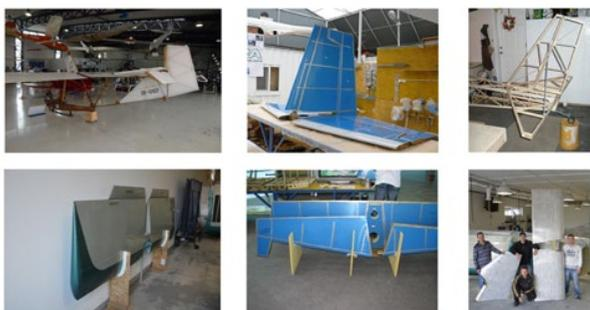
Рисунок 26. Конструкции оперения сверхлегких самолетов
