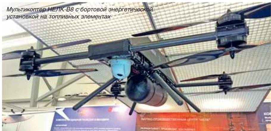
Мультикоптер НЕЛК-В8 с бортовой энергетической установкой на топливных элементах
