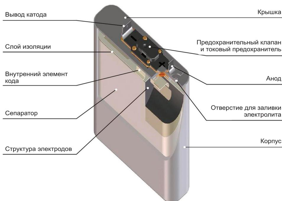
Рис. 3. Конструкция литиевого аккумулятора
