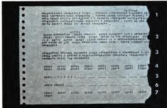
1. Сначала каждый реферат (а их сейчас в памяти машины более семнадцати тысяч) набивается на перфокарте и вводится в машину. «Минск-22» переносит его полностью, не забывая поставить впереди номер в виде кода 00251.
