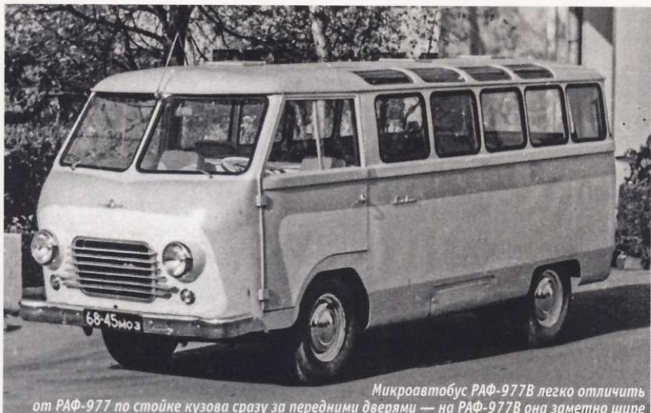
Микроавтобус РАФ-977В легко отличить от РАФ-977 по стойке кузова сразу за передними дверями — на РАФ-977В она заметно шире
