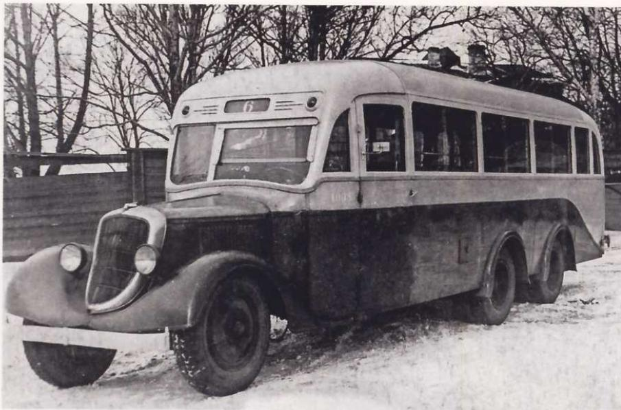
Автобус на трехосном шасси ЗИС-8а с третьей подкатной осью
