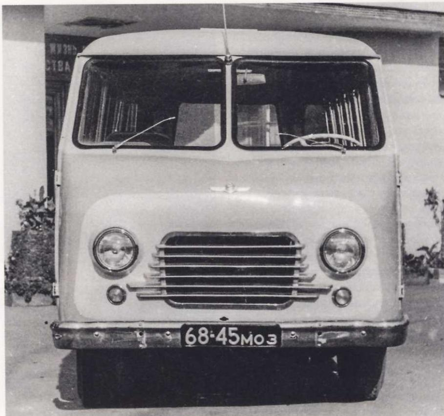
На РАФ-977В спереди стояли плоские ветровые стекла, а на следующей модели РАФ-977Д ветровое стекло станет единым и панорамным
