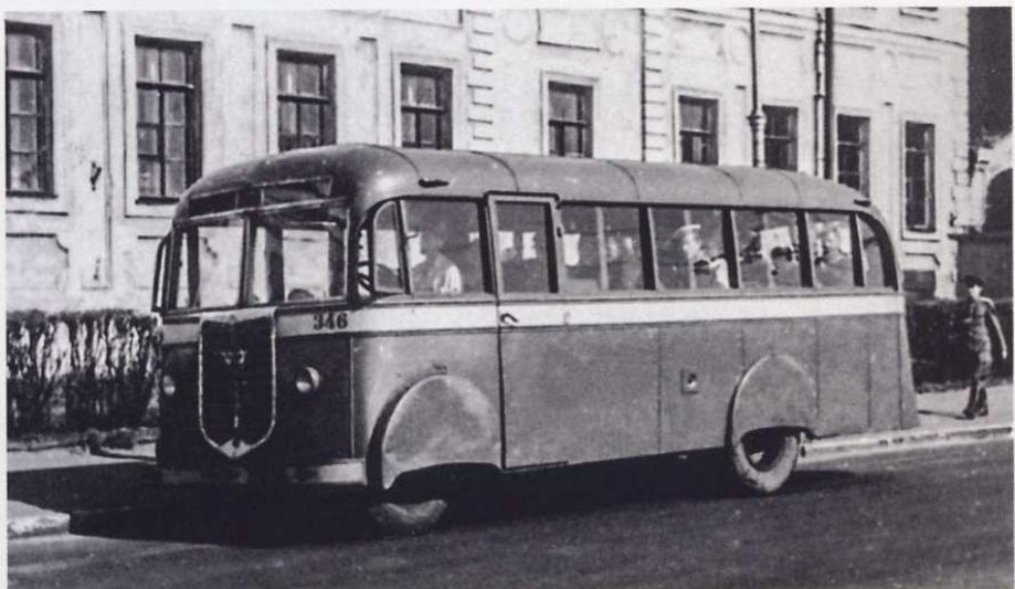
ных автобусов Л-4 на удлиненных шасси ЗИС-150 (с изготовлением новых лонжеронов рамы).
