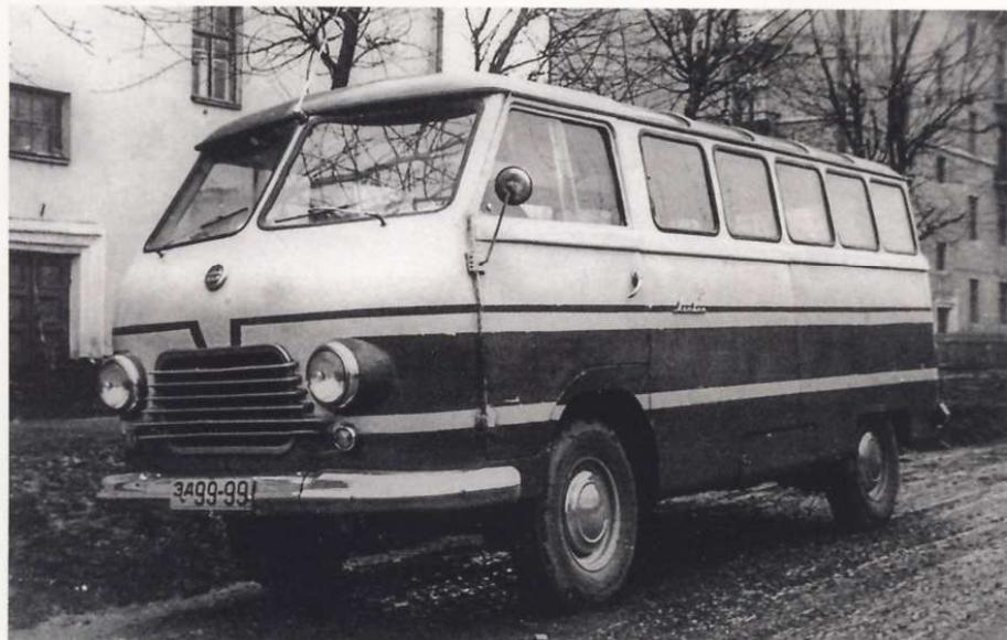
РАФ-977В «Латвия». На фото хорошо виден люк в юбке кузова для размещения запасного колеса
