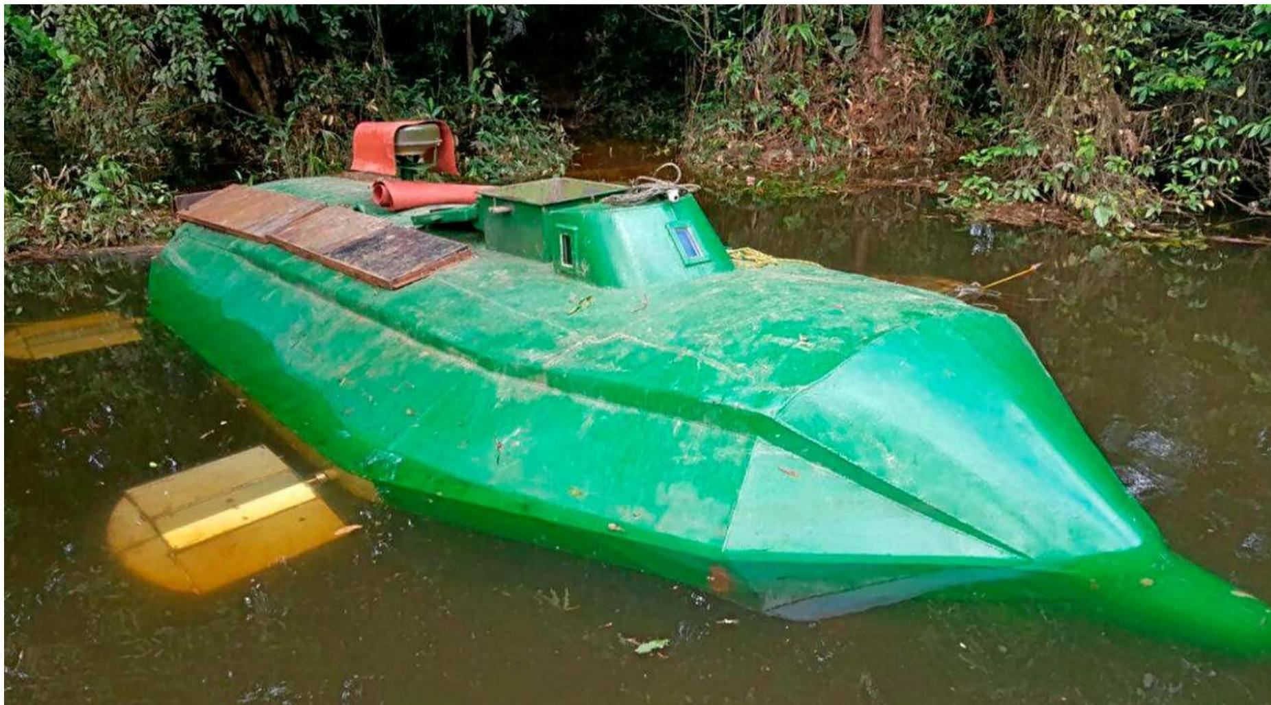
Este es el 'narco-submarino' más logrado intervenido por las Fuerzas Armadas de Colombia. Es de acero naval, se sumerge seis pies y navega con motores eléctricos. Indetectables para los radares. CORTESÍA DE LA ARMADA DE COLOMBIA
