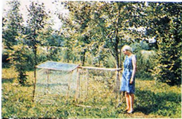
Так выглядят наши самодельные клетки, с их помощью мы проверяли, действительно ли на наших подопытных влияет экранирование от электрических полей.
