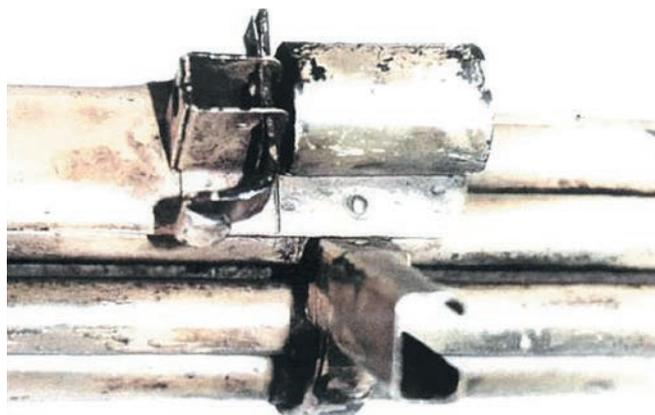
Детали ударно-спускового механизма Luftfaust-B. Слева на право: передняя направляющая для ударного стержня, предохранитель, индукционный генератор
