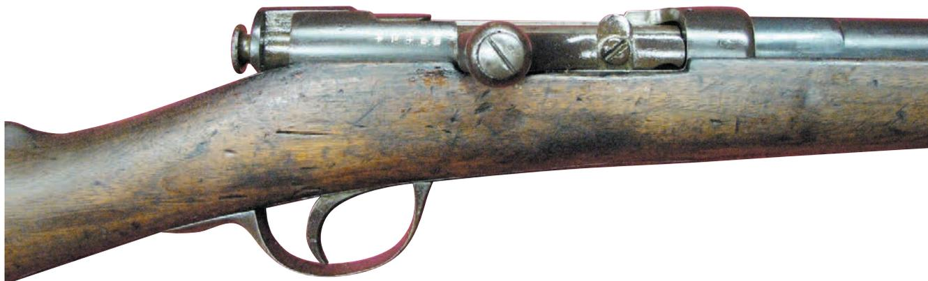
Винтовка системы Мураты тип 13 однозарядная с продольно-скользящим затвором. Винтовка появилась значительно позднее аналогичных европейских образцов, в её конструкции были использованы удачные технические решения, отработанные на европейских винтовках
