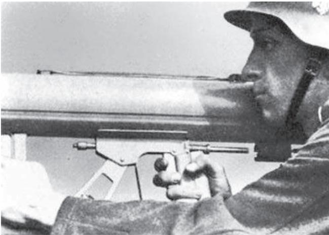
**Механизм электровоспламенения противотанкового гранатомёта RPzB 54 Panzerschreck**
