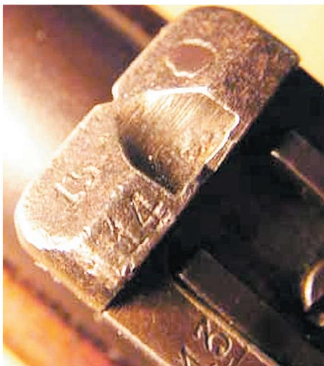
**Прицел винтовки системы Мураты с подъёмной планкой. Разметка прицела обеспечивает ведение огня на дальностях до 1500 шагов**
