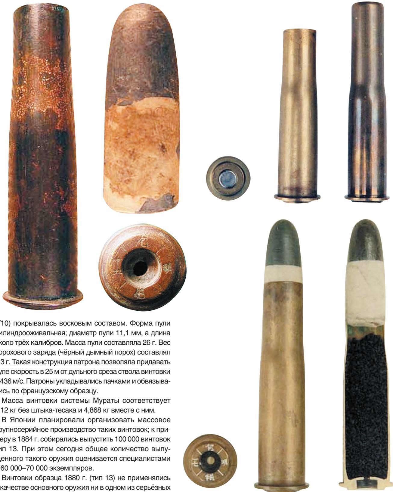
9/10) покрывалась восковым составом. Форма пули цилиндрикоживальная; диаметр пули 11,1 мм, а длина около трёх калибров. Масса пули составляла 26 г. Вес порохового заряда (чёрный дымный порох) составлял 5,3 г. Такая конструкция патрона позволяла придавать пуле скорость в 25 м от дульного среза ствола винтовки в 436 м/с. Патроны укладывались пачками и обвязывались по французскому образцу.
