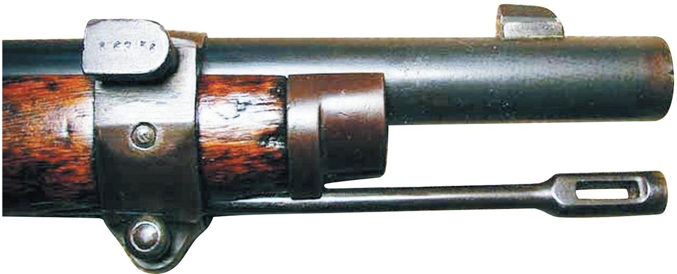
**На переднем кольце, с правой стороны винтовки, размещён выступ-кронштейн, предназначенный для фиксации штыка**
