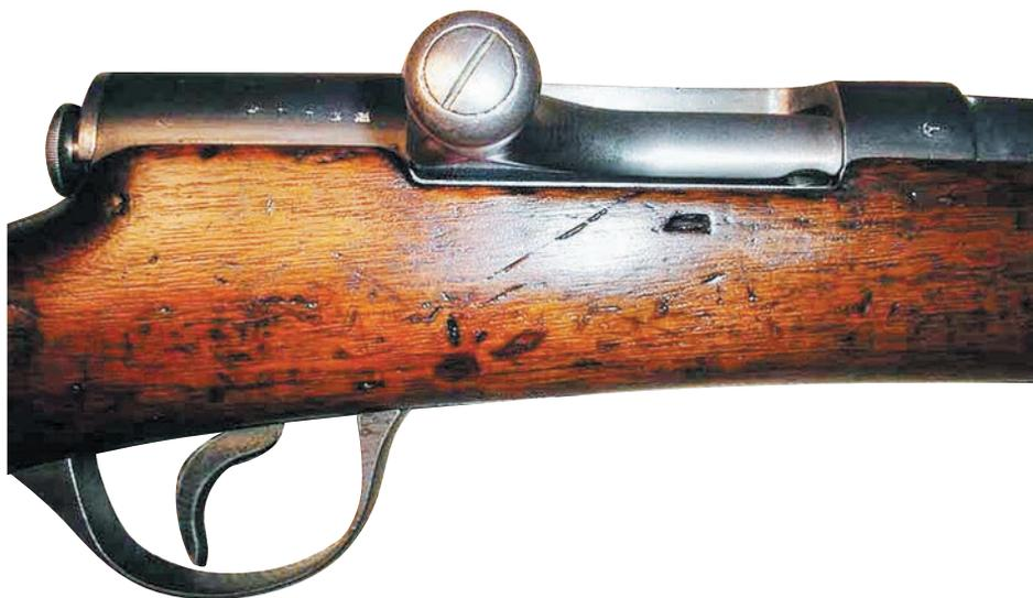
Интересной особенностью новых японских винтовок стало отсутствие витой боевой пружины, сообщающей энергию ударнику (вызывающей поступательное движение ударника). В винтовке Мураты функцию боевой выполняла коленчатая двухперьевая пружина, помещаемая внутри рукояти затвора. Такая пружина до этого использовалась в винтовках системы Бомона, принятых в Королевстве Нидерланды в 1871 г.
