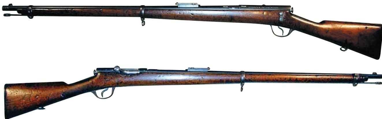
Винтовка системы Мураты тип 18. Это оружие пришло на смену типу 13 в 1885 г. Отличия между типами 13 и 18 незначительны, появление типа 18 связано с необходимостью исправления недостатков в конструкции, выявленных в течение нескольких лет эксплуатации и производства типа 13
