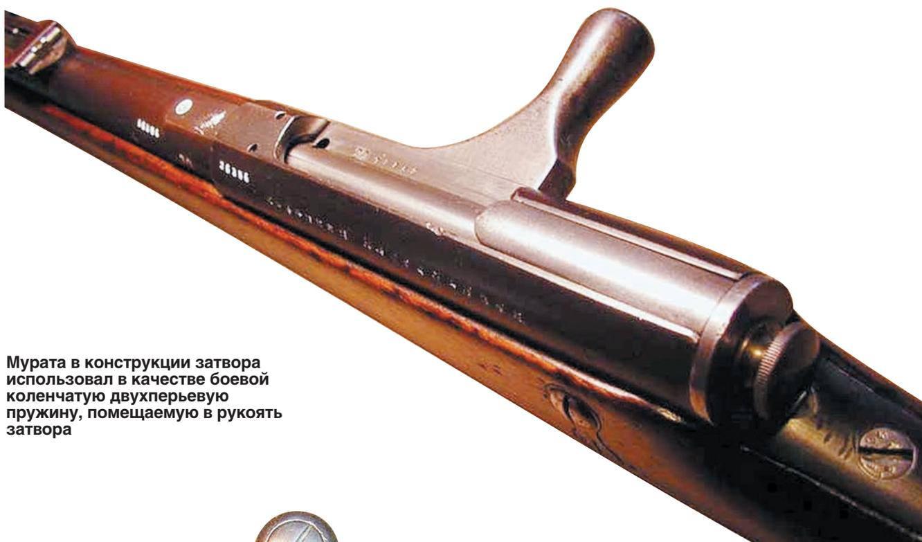
Мурата в конструкции затвора использовал в качестве боевой коленчатую двухперьевую пружину, помещаемую в рукоять затвора
