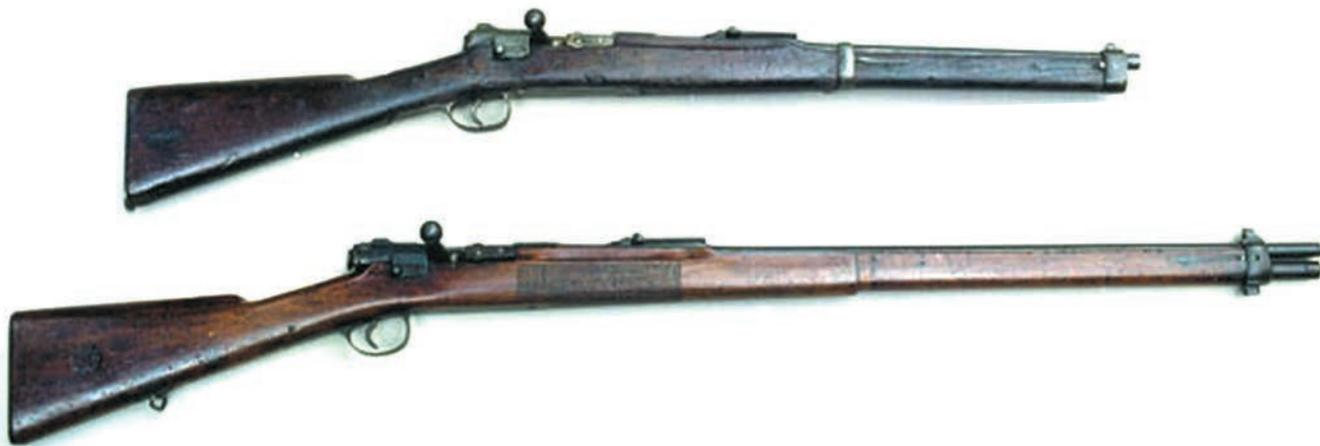
Карбин (сверху) и винтовка (снизу) системы Мураты (тип 22). Карбин 5-зарядный, а винтовка — 8-зарядная
