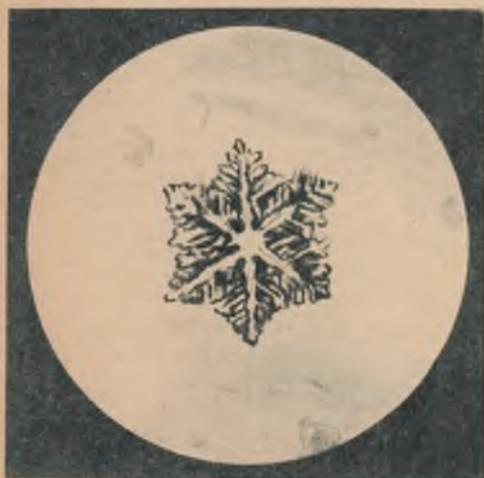
Микрофотография кристалла тридимита, образовавшегося в стекле во время выработки изделий. Такого рода кристаллы обычно являются признаком допущенных технологических ошибок при варке стекла, в данном случае признаком избыточного количества песка. Форма кристаллов дает указания о необходимых исправлениях технологического процесса. Увеличение — 378 раз.
