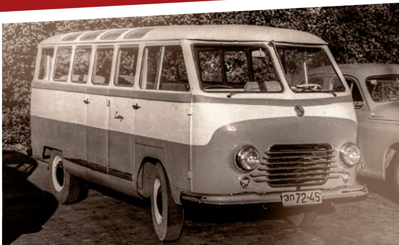
*Микроавтобусы «Латвия» базировались на агрегатах легкового автомобиля ГАЗ-21 «Волга»*
