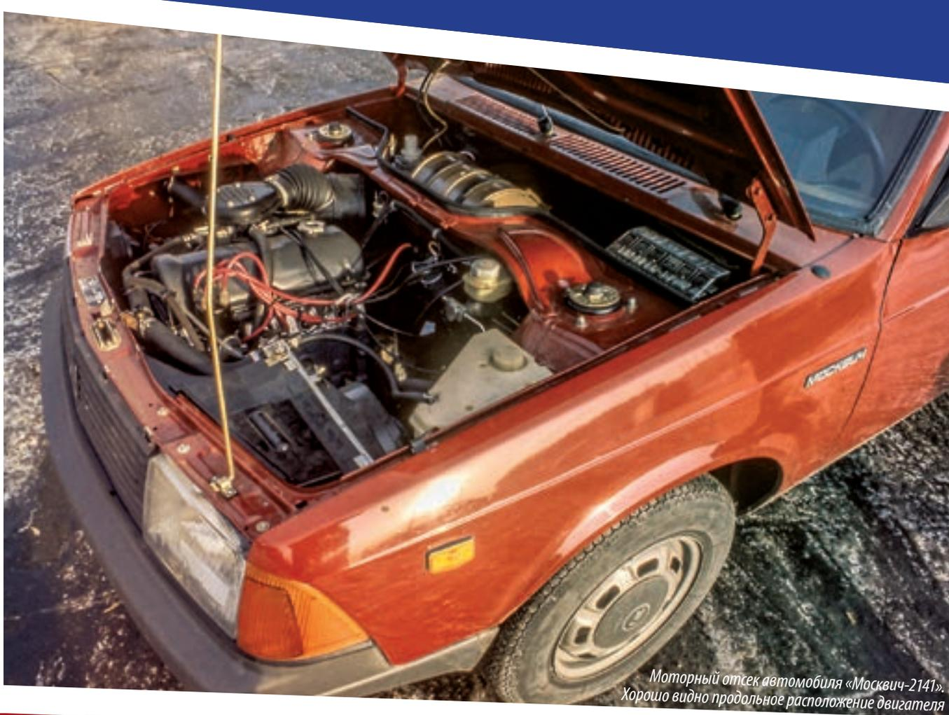
*Моторный отсек автомобиля «Москвич-2141». Хорошо видно продольное расположение двигателя*
