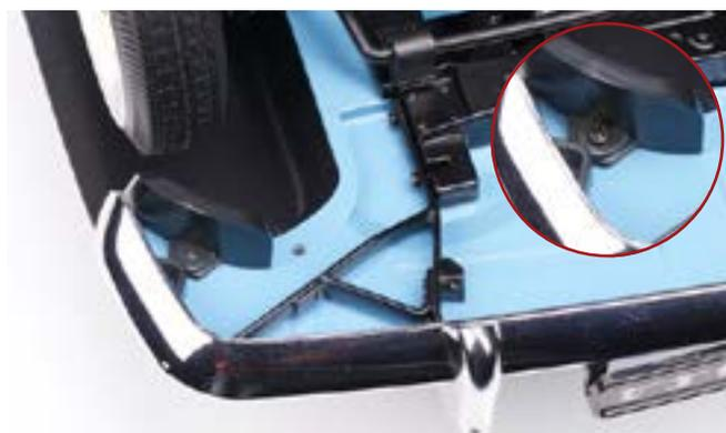
Установите накладку левого переднего крыла на переднем брызговике перед передним левым колесом (с нижней стороны шасси). Совместите крепежные отверстия деталей и зафиксируйте накладку винтом 2,0×4 (ВМ).
