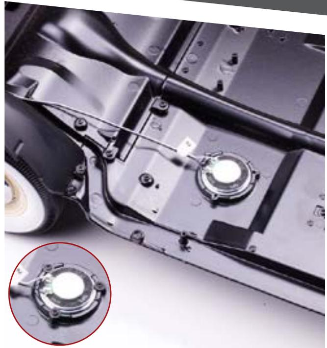
Установите динамик в средней части шасси модели. Совместите посадочное углубление с корпусом динамика и закрепите его тремя винтами 2,0×3 с пресс-шайбой (GM). Провода должны выходить в сторону задней части шасси модели.
