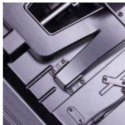
Поместите накладку заднего крепления рамы с внешней стороны окончания переднего левого лонжерона. Закрепите деталь на шасси при помощи двух винтов 1,7×4 (АМ).
