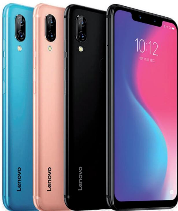
Аппарат получил дисплей Full HD+ с разрешением 2246 × 1080 точек и соотношением сторон 18,7:9. Размер экрана составляет 6,2 дюйма по диагонали. Заявлен 113-процентный охват цветового пространства sRGB; контрастность — 1500:1.
