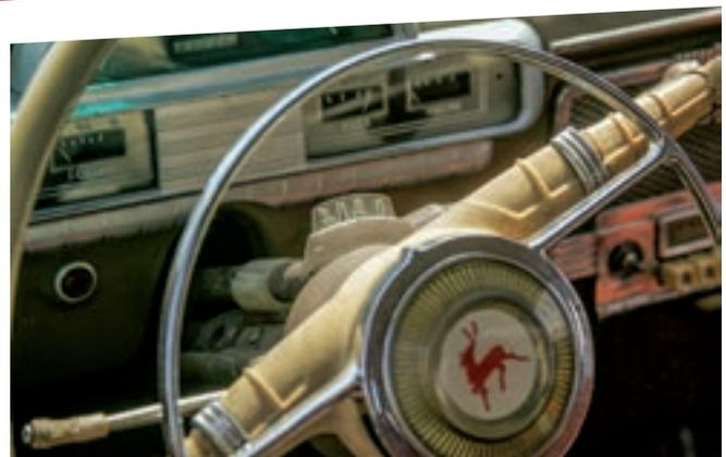
*Селектор автоматической коробки на рулевой колонке подсказывал водителю, какой режим движения задействован*
