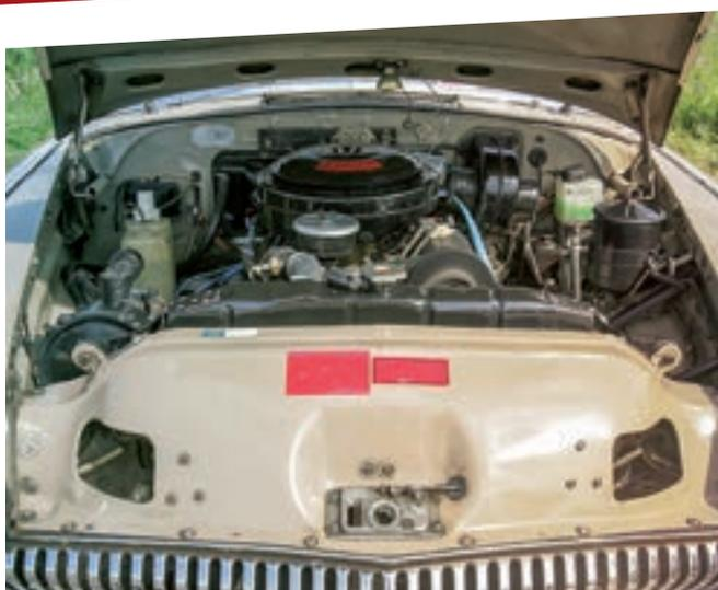
*Компоновка подкапотного пространства «Волги» с V-образным восьмицилиндровым мотором*
