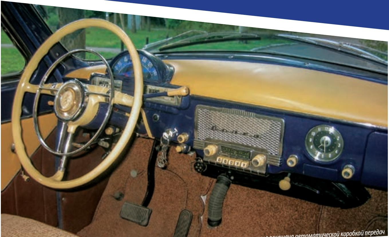
*Место водителя в ГАЗ-23. Хорошо видны всего две педали, однозначно указывающие на то, что машина оснащена автоматической коробкой передач*
