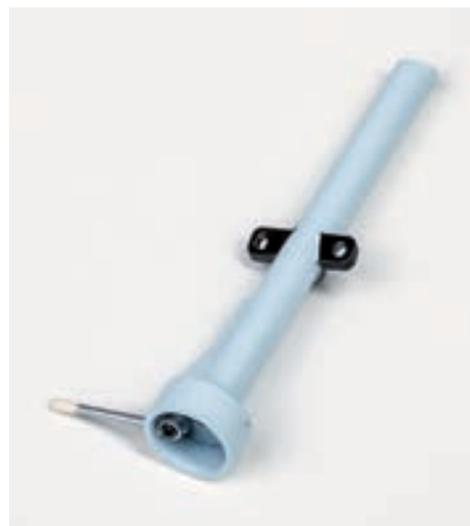
Установите в боковой прорези стакана колонки рулевого управления рычаг переключения указателей поворота. Совместите крепежное отверстие рычага с ответным отверстием внутри колонки. Закрепите деталь при помощи винта 1,5×4 (FP).
