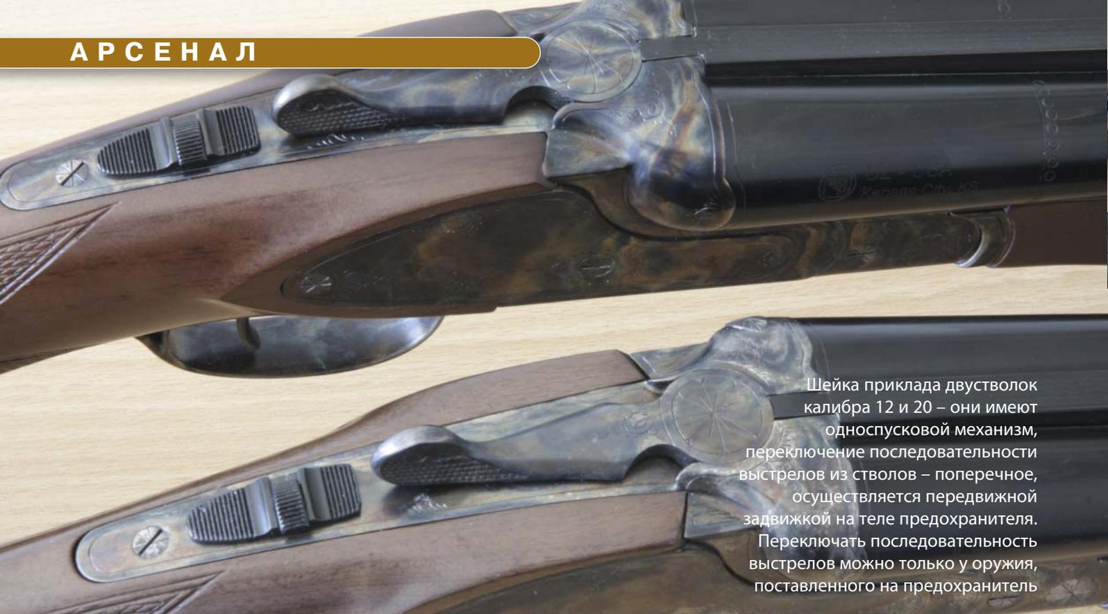
Шейка приклада двустволок калибра 12 и 20 – они имеют односпусковой механизм, переключение последовательности выстрелов из стволов – поперечное, осуществляется передвижной задвижкой на теле предохранителя. Переключать последовательность выстрелов можно только у оружия, поставленного на предохранитель
