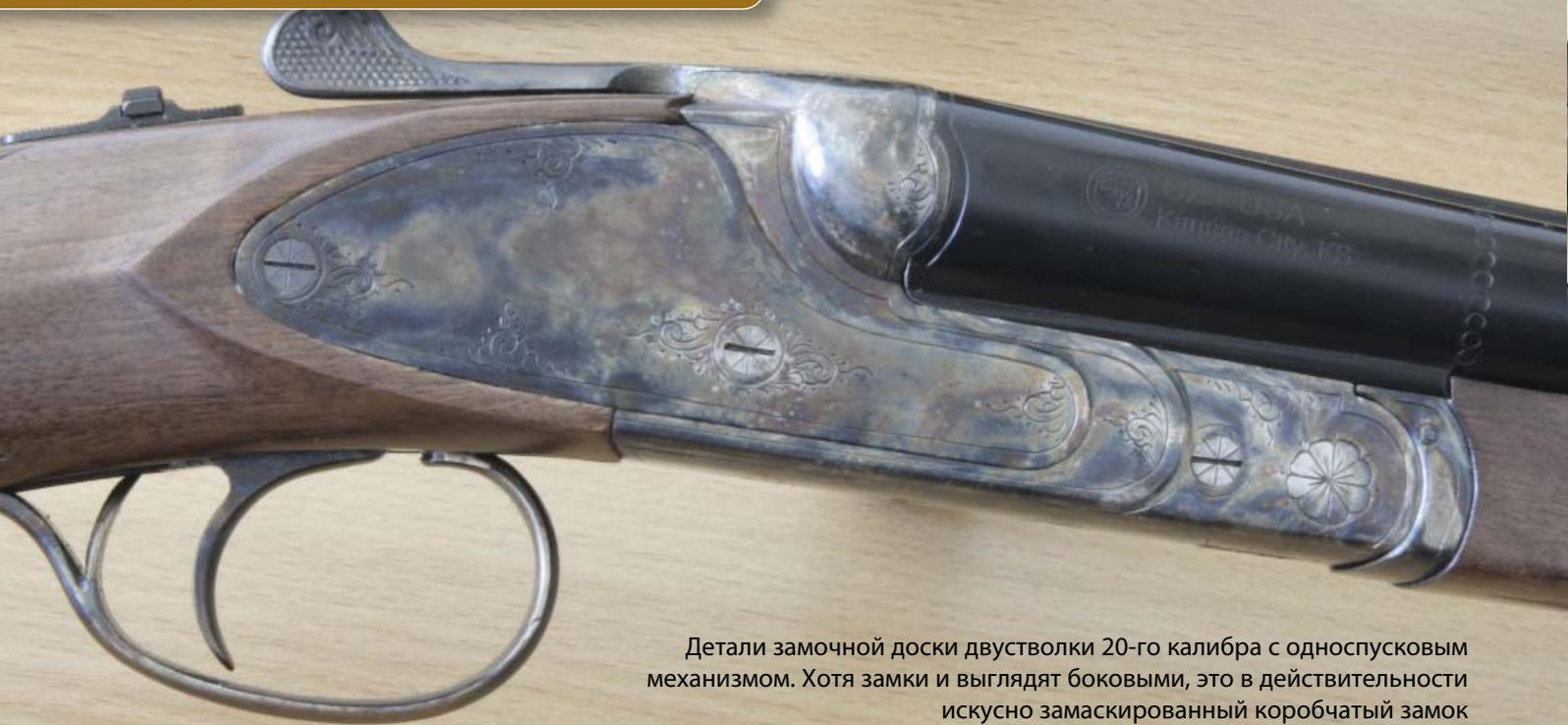
Детали замочной доски двустволки 20-го калибра с односпусковым механизмом. Хотя замки и выглядят боковыми, это в действительности искусно замаскированный коробчатый замок
