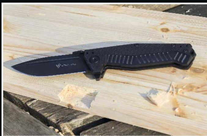
и коррозии. Нарезание лимона с нарочито нетщательным вытиранием на следующий день не оставил на клинке и режущей кромке никаких следов. Больших проблем с заточкой и доводкой ножа также не обнаруживается, несмотря на сильную твёрдость, сверхусилий она не требует. Высокие (чуть больше 20 мм) прямые спуски ножа начинаются прямо от дола, делая Bruiser прекрасным приспособленным для реза.
