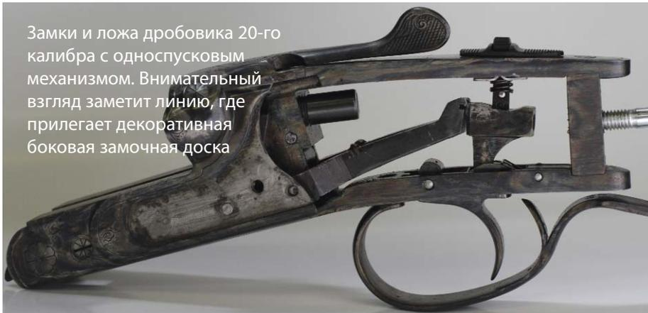
Замки и ложа дробовика 20-го калибра с односпусковым механизмом. Внимательный взгляд заметит линию, где прилегает декоративная боковая замочная доска
