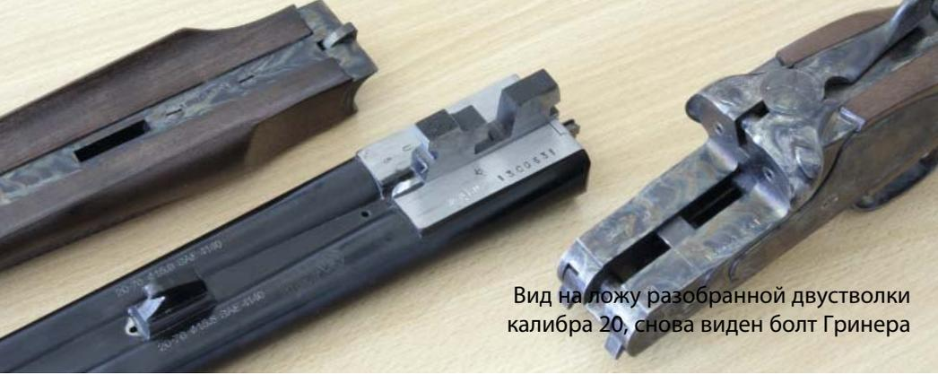
Вид наложу разобранной двустволки калибра 20, снова виден болт Гринера
