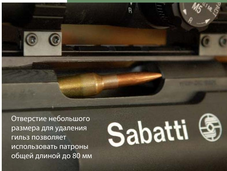
Отверстие небольшого размера для удаления гильз позволяет использовать патроны общей длиной до 80 мм
