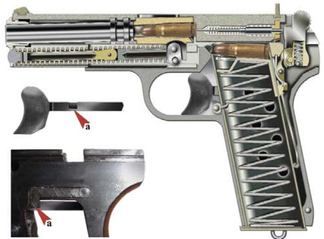
Разрез пистолета М.57 и магазинный предохранитель (а)
