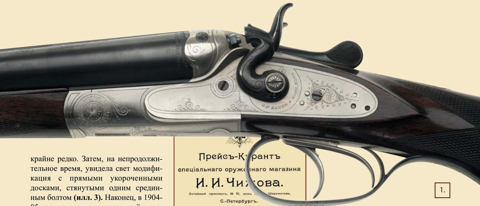
крайне редко. Затем, на непродолжительное время, увидела свет модификация с прямыми укороченными досками, стянутыми одним средним болтом (илл. 3). Наконец, в 1904-05 гг. появился окончательный вариант замков с двумя крепёжными элементами: впереди доски фиксировались к телу коробки винтами, а в средней части стягивались болтом (илл. 4). Две последние версии ружей производились несколько лет параллельно, причём, похоже, только в рядовом исполнении – без всякой гравировки.
