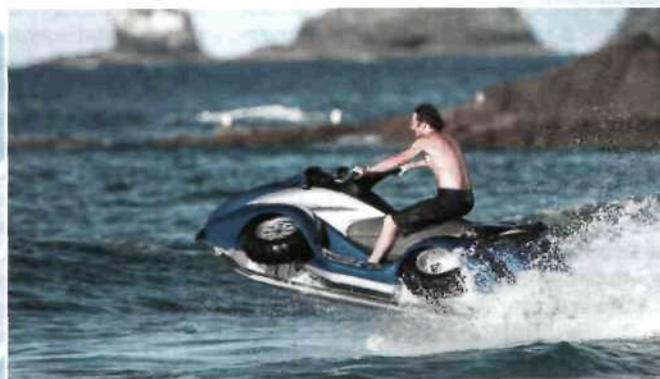
двигателя включается водомётный, и автомобиль убирает колёса в специальные ниши кузова. Управление на воде осуществляется за счёт поворота сопла водомёта, как на гидроцикле. Без дозаправки можно проплыть до 80 км. Дверей у Aquada нет — чтобы попасть в кабину, необходимо
