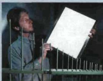
Измерение показателей электромагнитного излучения у плоской ксеноновой лампы «планон». Срок работы этой флуоресцентной лампы толщиной в 1 см более чем в два раза превышает срок работы традиционных флуоресцентных ламп
