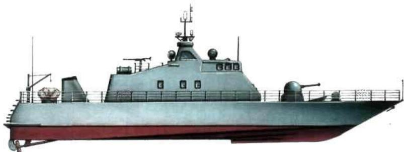
**Многоцелевой, в том числе для охраны рыболовной зоны, катер «Икар» (проект разработан в 90-е гг., Россия): водоизмещение — 99 т, скорость — 45 узлов, вооружение: 30-мм пушка и пулемёт, мощность силовой установки — 5120 кВт, дальность плавания — 500 миль, длина — 35 м, ширина — 7,8 м, осадка — 2 м, экипаж — 6–14 человек. Состав вооружения может изменяться по желанию заказчика**
