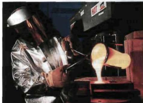
Так переливают только что вынутое из плавильной печи расплавленное стекло — очищенное от свинца и специально разработанное для производства электрических лампочек
