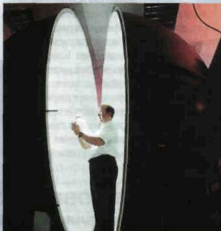
Так называемая интегрирующая сфера, или сфера Ульбрихта, используется для изучения света флуоресцентной лампы Эндюра. Специальным сенсором определяют интенсивность излучения лампы по отражению от внутренней поверхности закрытой сферы
