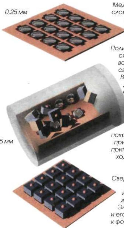
Медные квадратики кладутся слоем на гибкую пластиковую основу, каждый из них покрывается припойным контактом
