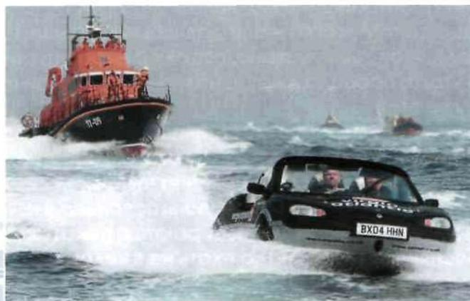
довать сам агент 007. Один из трансформеров серии, названный Aquada, являясь на суше спортивным автомобилем, способен за 12 с преобразоваться в быстроходный глиссирующий катер, развивающий скорость до 50 км/ч. При переходе с суши на воду в амфибии вместо шестицилиндрового
