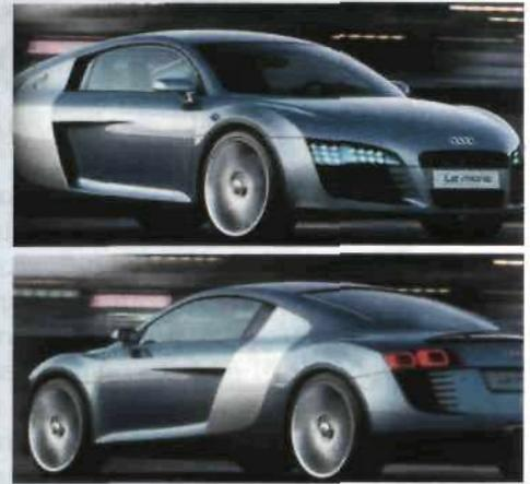
**Уникальные светодиодные блок-фары Audi Le Mans — лишь один из конструктивных элементов, составляющих облик передней части машины. Контуры левой и правой фар, под прозрачным нерифленым стеклом которых видны по 17 светодиодных блоков с каждой стороны. Внизу они поддерживаются обширными проёмами воздухозаборников, забранными горизонтальными решётками**
