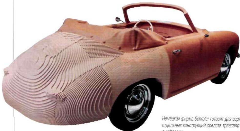
Немецкая фирма Schröter готовит для серийного производства композитные части и компоненты отдельных конструкций средств транспорта. Эти дизайн-модели созданы с помощью лазерной оцифровки
