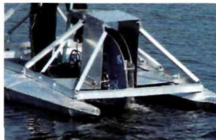
Колёсно-лопастной механизм, вид сзади
