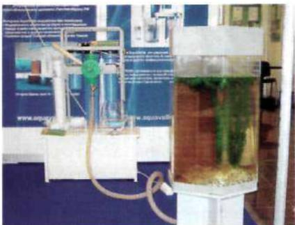
Фильтровальный материал и устройство водоочистки AquaVallis. Действие материала определяется содержащимися в нём пористыми наночастицами, на поверхности которых в водной среде возникает электрокинетический потенциал. AquaVallis позволяет удалять из водных сред как микроорганизмы (в том числе вирусы), так и взвешенные твердые частицы с эффективностью 99,999999–100%. Материал находится в серийном производстве. Научно-производственное предприятие ООО «Аквазон», г. Томск
