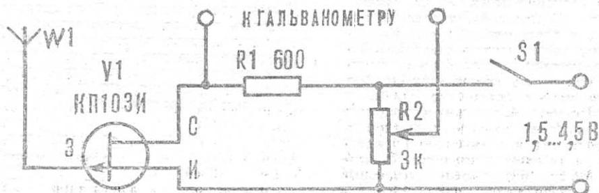
Для демонстрации опытов по электростатике предлагаю схему приставки к школьному гальванометру. Потерев о ткань эбонитовую или стеклянную палочку, ее подносят на расстояние до 1 м к антенне W1 — отрезку провода длиной 20—30 см, подсоединенного к затвору полевого транзистора V1. На наличие электрического заряда указывает отклонившаяся стрелка гальванометра.
