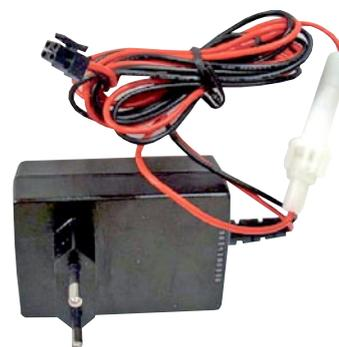
Рис. 4. Модифицированный сетевой адаптер ES18E12-WAVECOM для GSM/GPRS-модемов Wavacom
