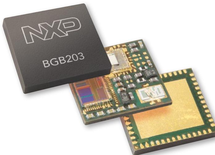
Рис. 1. Bluetooth-модуль BGB203
