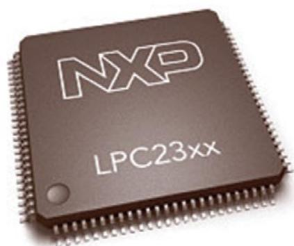
Не так давно компания NXP Semiconductors анонсировала новое семейство 32/16-разрядных микроконтроллеров с ядром ARM7TDMI-S — LPC23xx (см. табл. 1), предназначенных в основном для применения в промышленности. Микроконтроллеры снабжены двойной высокоскоростной шиной (АНВ) для обеспечения независимой работы периферийных устройств с высокой пропускной способнос-
