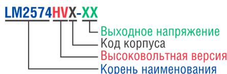
Рис. 6. Расшифровка наименования импульсных регуляторов National Semiconductor
