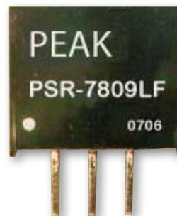
Рис. 1. Внешний вид импульсного стабилизатора PSR-78xxLF
