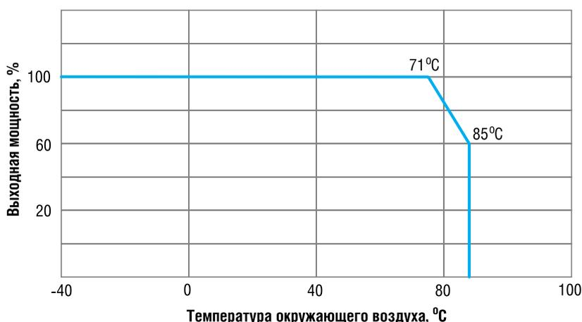
Рис. 2. Диапазон рабочих температур импульсных стабилизаторов серии PSR-78xxLF
