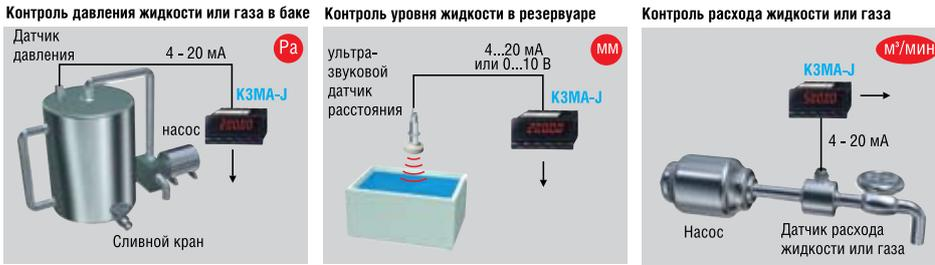
Рис. 2. Примеры типовых применений цифровых панельных индикаторов-измерителей
