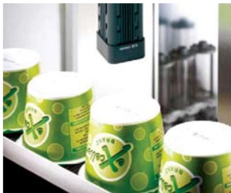
Рис. 5. Пример применения датчика ZVF: проверка напечатанной информации об изделии на высокоскоростной линии упаковки
