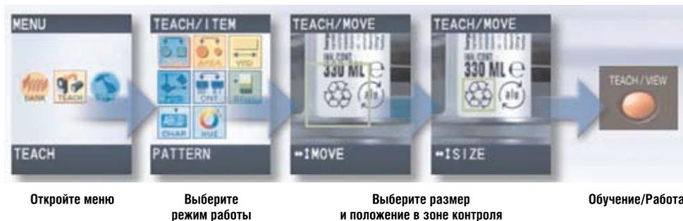
Рис. 3. Удобный интерфейс и простая настройка датчика ZVF
