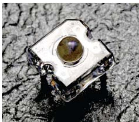
Рис. 14. Сверхъяркие светодиоды в корпусе P4 (Пиранья)
