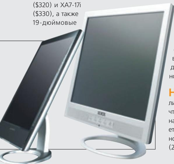
XA7-19i (эти — в двух модификациях: со временем отклика 20 мс за \$500 и 8 мс за \$530). Первые обеспечивают контраст 500:1 и яркость 300 кд/кв. м, вторые соответственно 800:1 и 250. Все мониторы имеют защитно-антибликовое покрытие Xshield. Кроме того, появилась ЭЛТ-модель: 17-дюймовый XC-778 (\$140) с плоским экраном.
