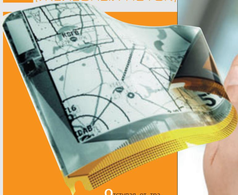
Отступая от традиции «Железного потока» сообщать о готовых к продаже новинках, рискнем заглянуть в ближайшее будущее и отметим прорыв в области гибких ЖК-дисплеев. Фирма Philips Polymer Vision умудрилась сконструировать 5-дюймовый дисплей PV-QML5, который может скручиваться в трубочку диаметром всего 15 мм. Он имеет разрешение 320x240 точек, контрастность 10:1 и четыре градации яркости.
