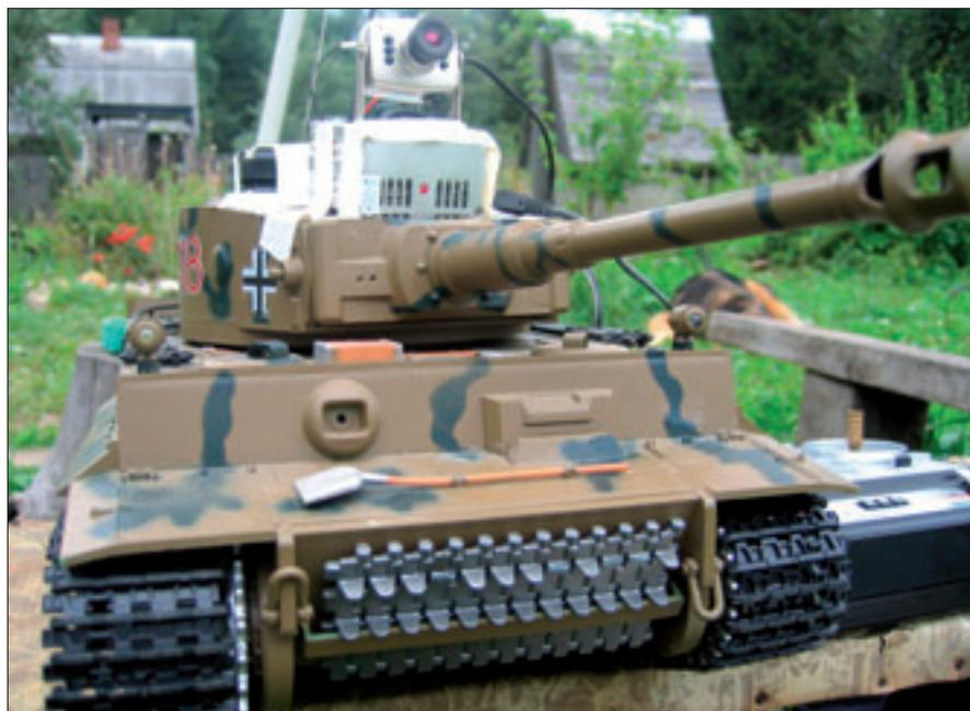
Теперь о шасси, на которое хотелось бы установить телеметрическую систему. Масштаб танка должен быть минимум 1:10–1:8. Только при таких размерах модель может преодолевать более или менее серьезные препятствия. И нагрузка на шасси будет допустимой — 1–1,5 кг минимум. Этим условиям удовлетворяют только отечественные
