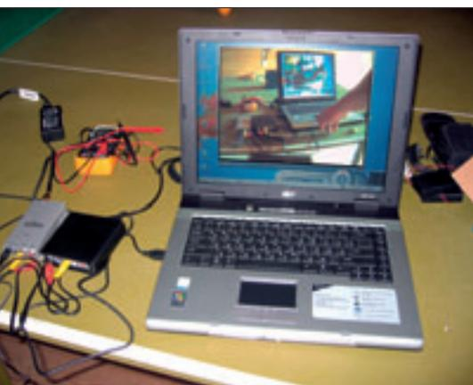
▲ Схема получилась такая: приемник (1,2 ГГц) был подключен к композитному входу Aver, а Aver — к USB-порту ноута Acer
