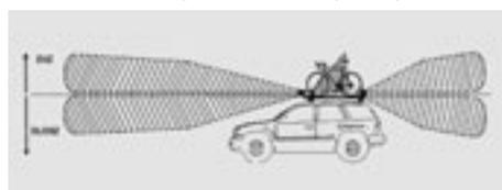
бампере, а на крыше. Четыре датчика предлагается использовать для контроля зон выше и ниже крыши в обоих направлениях движения, а при отсутствии багажа — просто отключать два верхних датчика.
