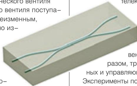
Если два летящих по соседним волноводам фотона одновременно попадают на участок сближения, то фотоны испытывают там квантовую интерференцию и «запутываются» между собой. Весь оптический вентиль CNOT работает довольно хитрым образом, трижды «перепутывая» фотоны из пар входных и управляющих волноводов.
