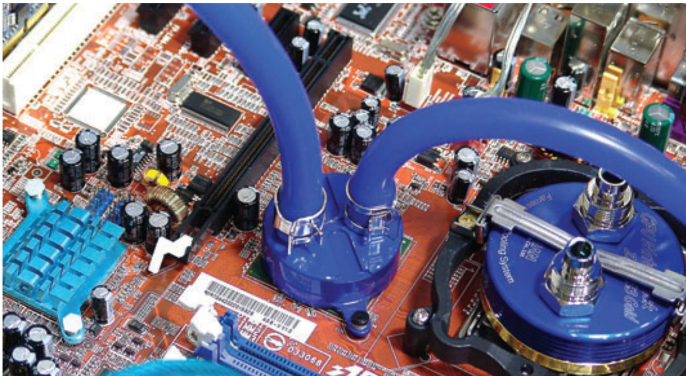
ция, состоящая из пяти основных элементов: водоблока, снимающего тепло с процессора; радиатора, водяной помпы, соединительных шлангов и резервуара, он же расширительный бачок. Единственным специальным устройством из перечисленных является только водоблок, все остальные можно соорудить из различных подручных предметов. Водоблок — всему голова, с него и начнем.
