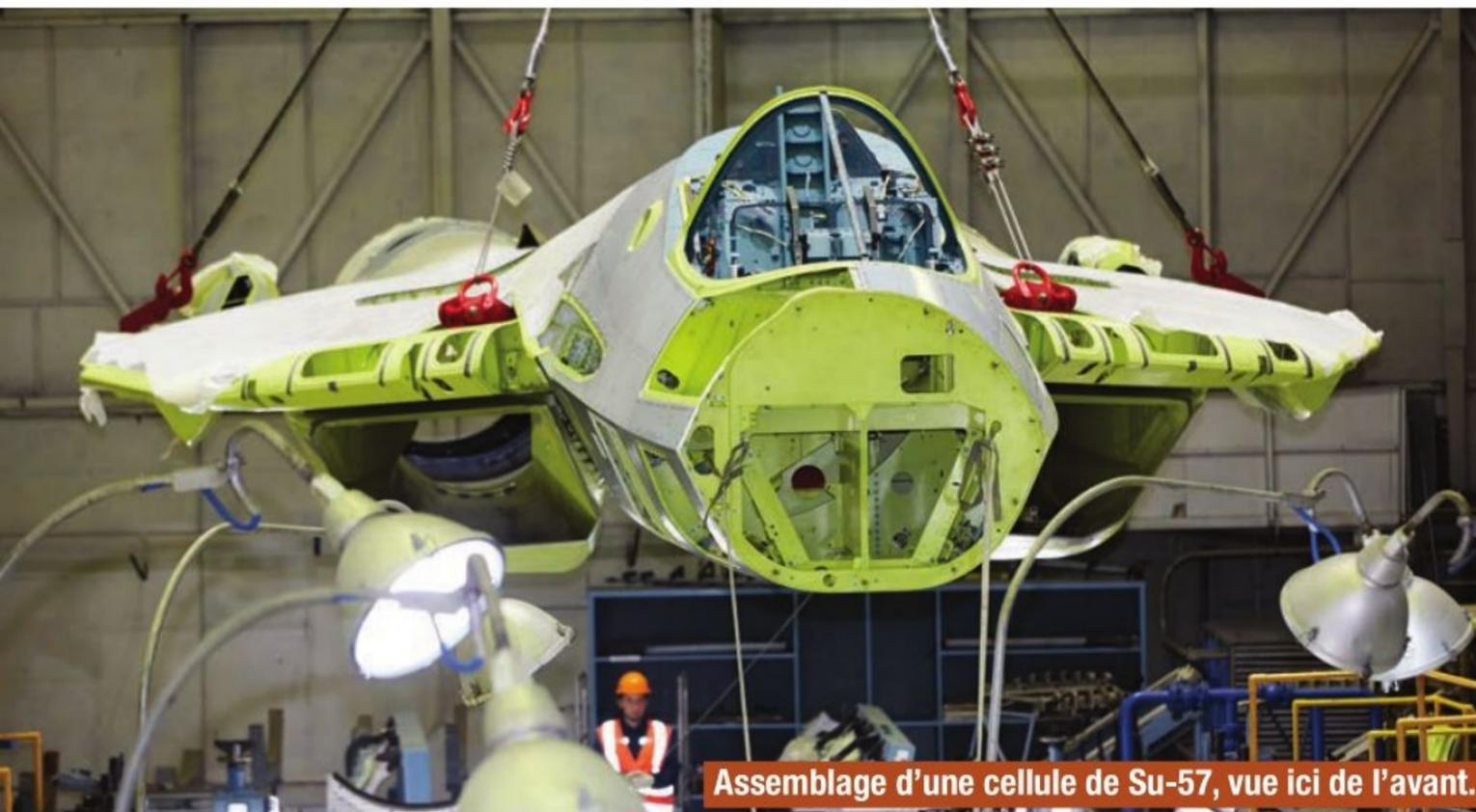
Assemblage d'une cellule de Su-57, vue ici de l'avant.
