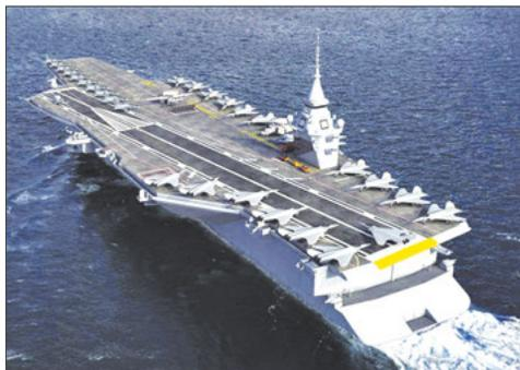
По данным портала, проектная длина PANG более 280 м, а водоизмещение по меньшей мере 70 000 т. Длина ABMA «Шарль де Голль» составляет 238 м, а водоизмещение – 43 200 т. При этом каждый из двух атомных реакторов K15 на борту авианосца выдает мощность на уровне 150 МВт, в то время как два реактора нового поколения K22, которые установят на новом корабле, смогут выдавать суммарно до 450 МВт.
