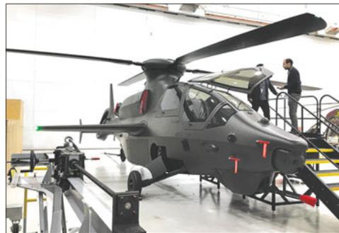
пушка, а также ракеты класса «воздух – поверхность», часть из которых размещается во внутренних отсеках. Кроме того, вертолет может нести бомбы или контейнеры с различным вооружением или оборудованием. Его скорость 333 км/ч. Вертолет можно перевозить транспортными самолетами С-17 «Глоубмастер-3».
