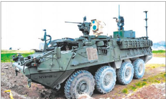
*Мобильный высокоэнергетический лазер, установленный на БТР «Страйкер»*
