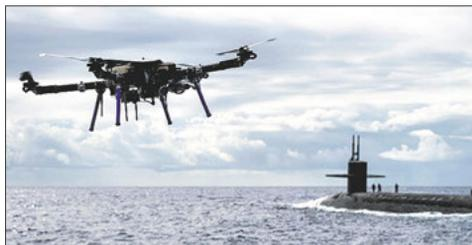
(ПЛ) к другой во время нахождения их на патрулировании. В частности, ранее были проведены испытания по доставке с помощью беспилотника небольшого груза на ПЛАРБ типа «Огайо». Кроме того, таким же образом планируется передавать на ПЛ приказы, разведывательную информацию и прочие данные на физических носителях.
