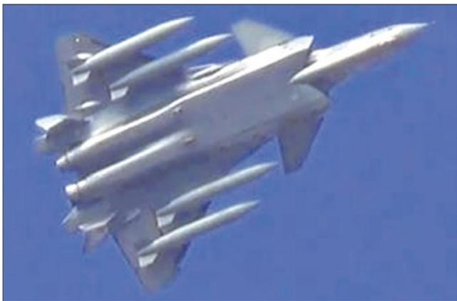
*Истребитель «Цзянь-20» с подвесными топливными баками*
