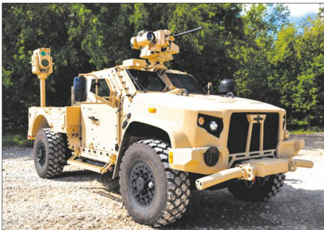
*Мобильная лазерная установка, разработанная фирмами «Боинг» и «Дженерал атомикс» для борьбы с малоразмерными БПЛА на поле боя*
