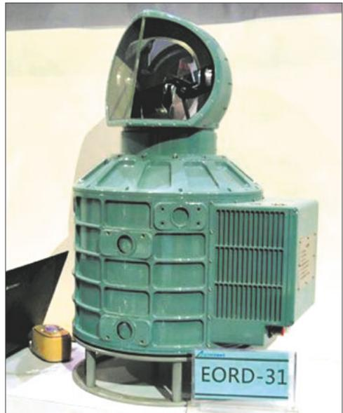
*Бортовая поисково-слеящая система переднего обзора EORD-31 самолета «Цзянь-20»*
