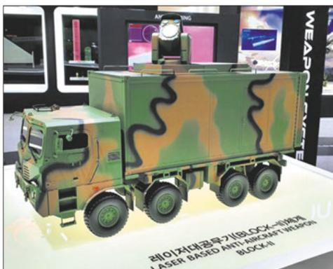
Ожидается, что система блок-1, разработка которой началась в сентябре 2019 года, будет способна обнаруживать и сопровождать небольшие беспилотные летательные аппараты и нейтрализовывать их на малой дальности (до 3 км) с помощью лазера мощностью 20 кВт.
