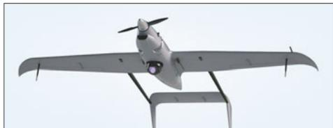
более совершенным программным обеспечением и возможностью установки дополнительной полезной нагрузки. Высота полета аппарата 4 500 м, продолжительность более 24 ч, крейсерская скорость 120 км/ч, дальность действия канала радиопередачи 240 км.
