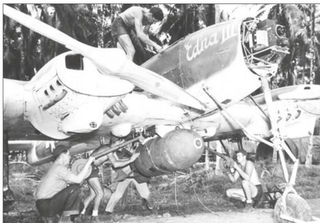
*Беспилотный самолет **TDR-1** во время предполетной подготовки (в носовой части телевизионная камера «Блок-1», защитный кожух снят)*
