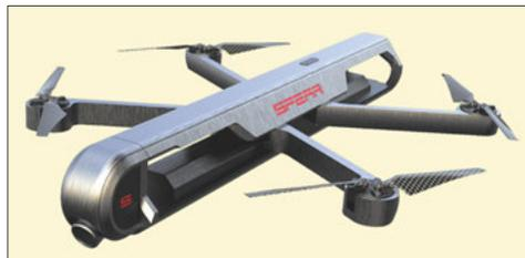
дивидуальном бронежилете бойца в ходе боевых действий. Продолжительность полета БПЛА составляет 40 мин; он оснащен оптико-электронными датчиками с дневным и ночным каналами, а также оборудованием автоматического слежения.
