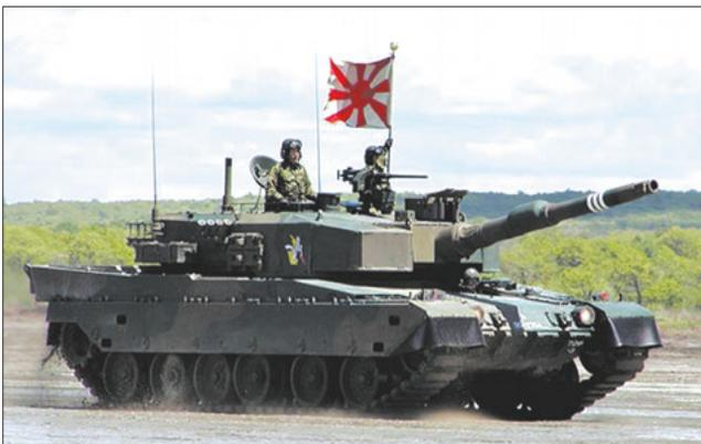
*Компания «Мицубиси дзюкогё» является ведущим производителем бронетанковой техники. На рисунках – основной боевой танк тип «90» (вверху) и самоходная артиллерийская установка тип «99» (внизу)*
