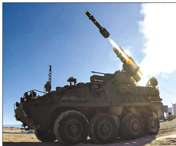
источника, находящегося в боевых порядках подразделения. Сопровождение осуществляется при помощи оптики, она же отвечает за наведение ствольных систем. В зависимости от типа цели и дальности до нее возможно применение ствольного или ракетного вооружения. Максимальная дальность поражения воздушных целей 6–8 км в зависимости от погодных условий.
