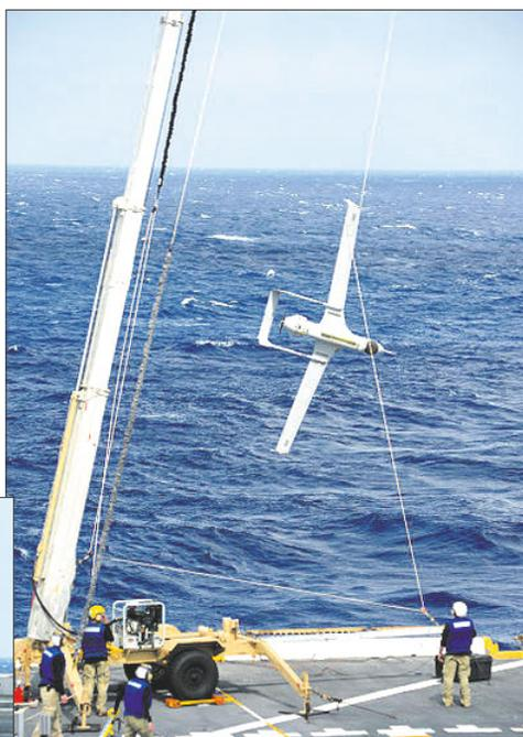
*Пусковая установка и устройство «Скай Хук», обеспечивающее посадку БПЛА «Блэк Джек»*
