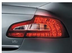
Светодиодные задние фонари (кроме Superb Combi<sup>1</sup>)
