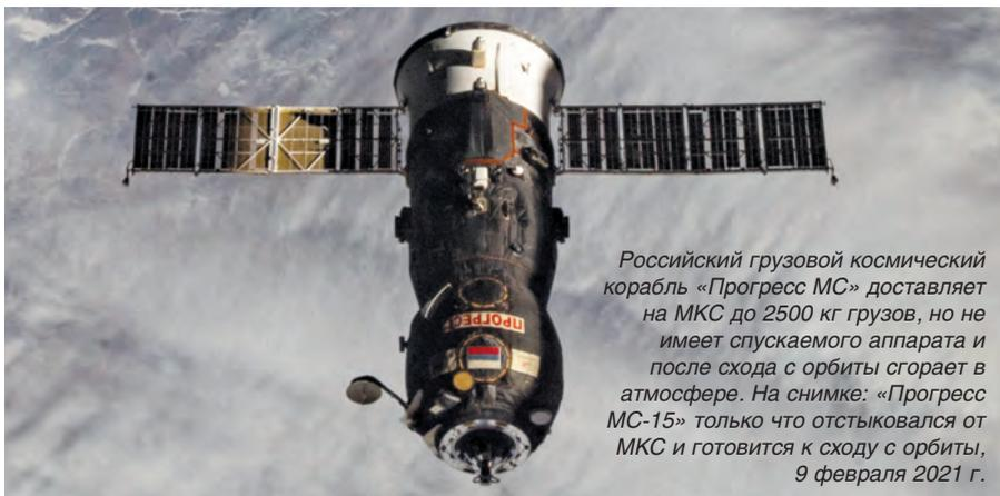
Российский грузовой космический корабль «Прогресс МС» доставляет на МКС до 2500 кг грузов, но не имеет спускаемого аппарата и после схода с орбиты сгорает в атмосфере. На снимке: «Прогресс МС-15» только что отстыковался от МКС и готовится к сходу с орбиты, 9 февраля 2021 г.
