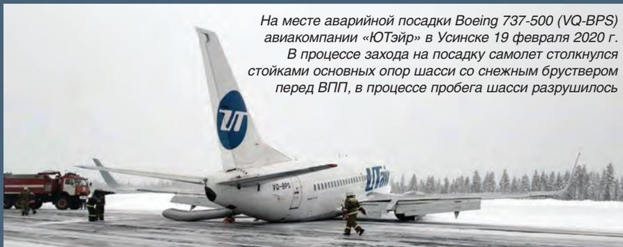
На месте аварийной посадки Boeing 737-500 (VQ-BPS) авиакомпании «ЮТэйр» в Усинске 19 февраля 2020 г. В процессе захода на посадку самолет столкнулся стойками основных опор шасси со снежным бруствером перед ВПП, в процессе пробега шасси разрушилось
