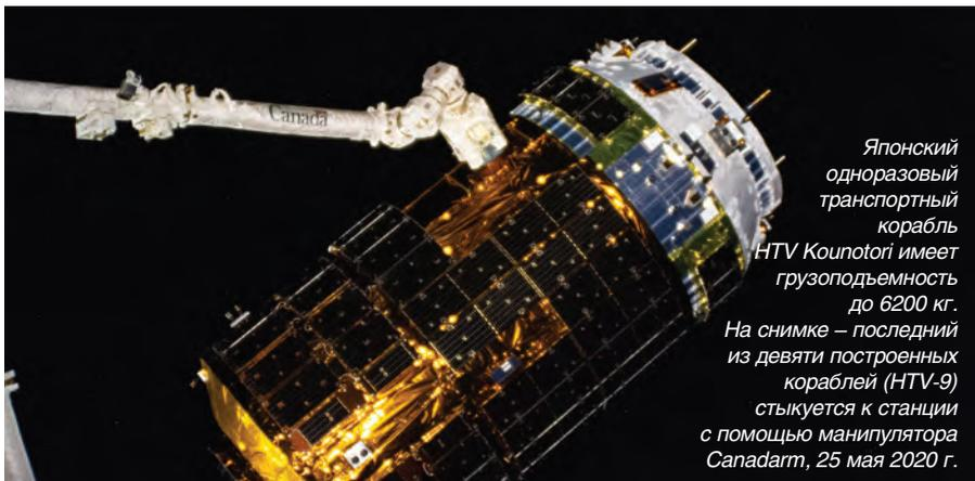
Японский одноразовый транспортный корабль HTV Kounotori имеет грузоподъемность до 6200 кг. На снимке – последний из девяти построенных кораблей (HTV-9) стыкуется к станции с помощью манипулятора Canadarm, 25 мая 2020 г.
