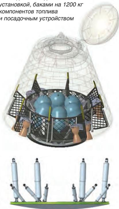
Посадочное устройство корабля «Арго», которое представляет собой выдвигной амортизированный щит, обеспечивающий безопасную посадку на неподготовленной поверхности
