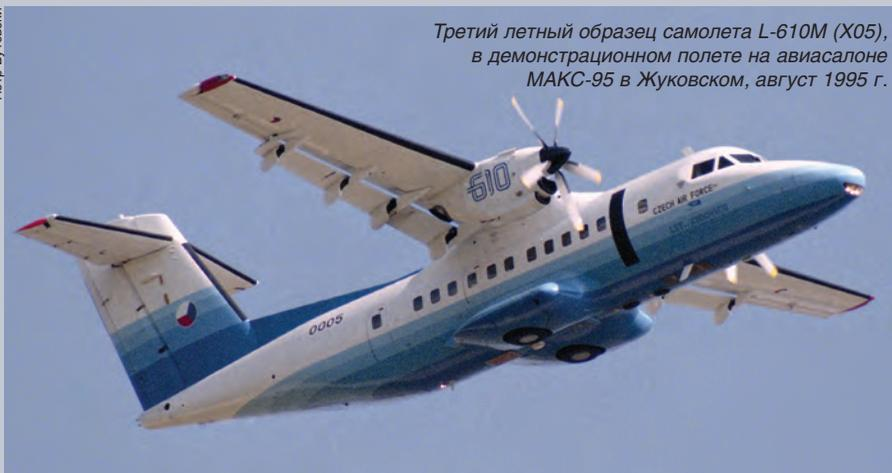
в таком варианте чешский самолет сможет быть востребован мировым рынком, в связи с чем L-610 в первой половине 90-х регулярно прилетали на различные международные авиасалоны. Модификация самолета с двигателями СТ7-9D мощностью 1950 л.с. с четырехлопастными воздушными винтами Hamilton Standard HS14RF-23 получила название L-610G. Для отличия от нее вариант с M602 стал называться L-610M.
