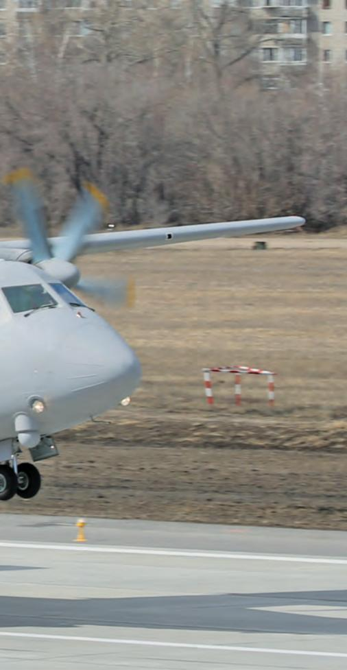
турах воздуха. По данным ОАК, Ил-112В, имеющий максимальную взлетную массу 21 т, будет совершать полет с крейсерской скоростью 470–500 км/ч на высотах до 7600 м, дальность полета с максимальной нагрузкой 5 т должна составить 1200 км, дальность с грузом 3,5 т — 2400 км.
