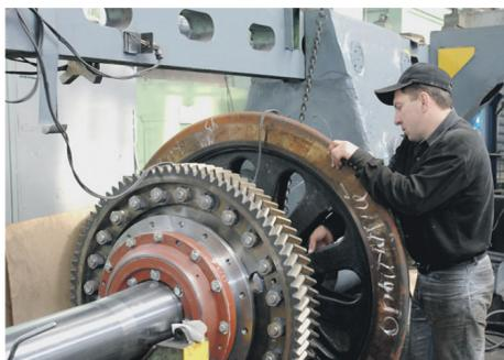
Специалисты столичного Института электрохимического оборудования (ВНИИЭТО) предложили для термообработки поверхности зубчатых колёс локомотивов и других быстро изнашивающихся частей механизмов применять способ ионного азотирования.
