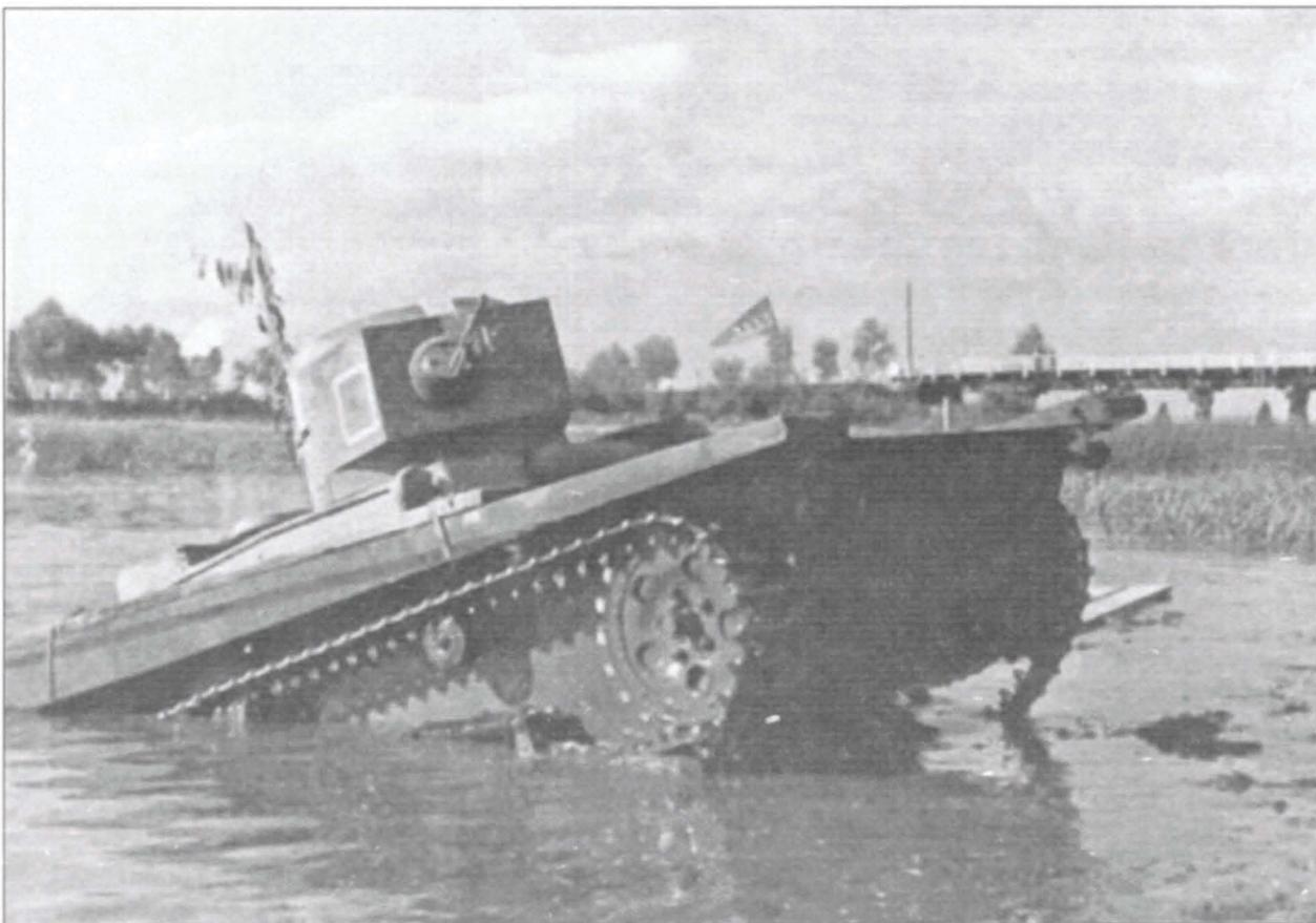
*Легкий плавающий танк Т-37 выходит из реки на берег. Танки этого типа участвовали в опытах А. Кравцева в ОКДВА*
