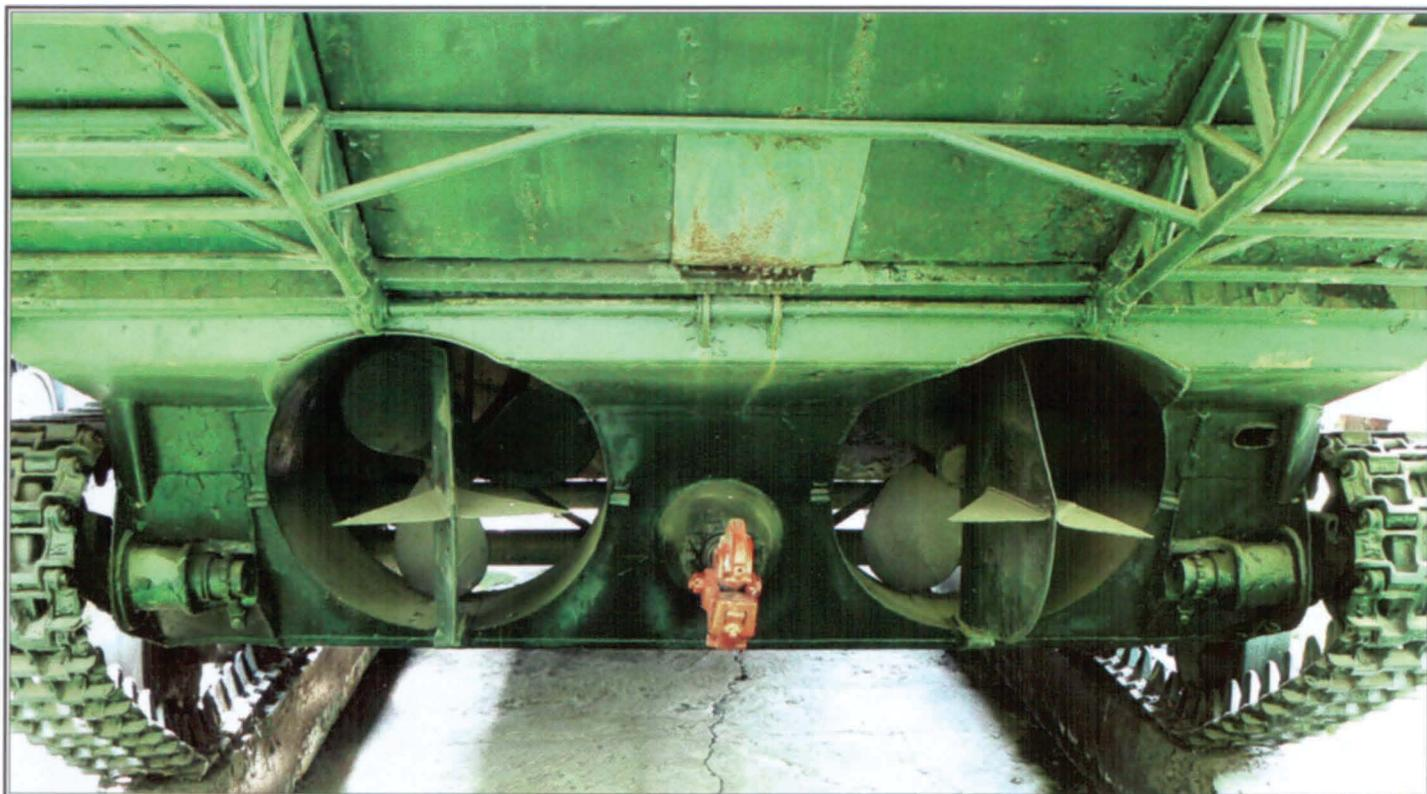
*Кормовая часть К-61. Хорошо видны гребные винты в тоннелях-насадках и два пера рулей.
