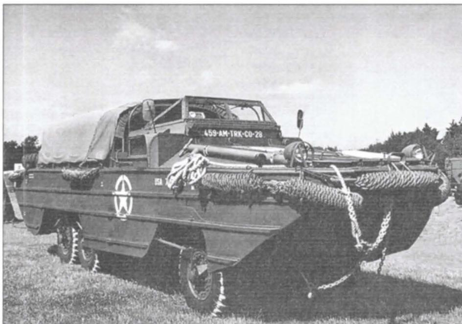
*Американский трехосный полноприводной плавающий автомобиль GMC DUKW-353, применявшийся в РККА*
