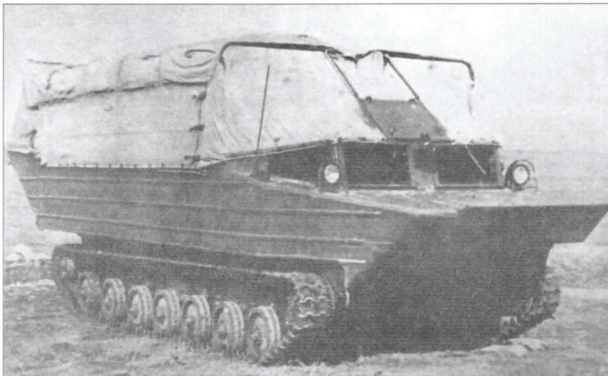
Гусеничный плавающий транспортер К-61 с комплектом морского оборудования
