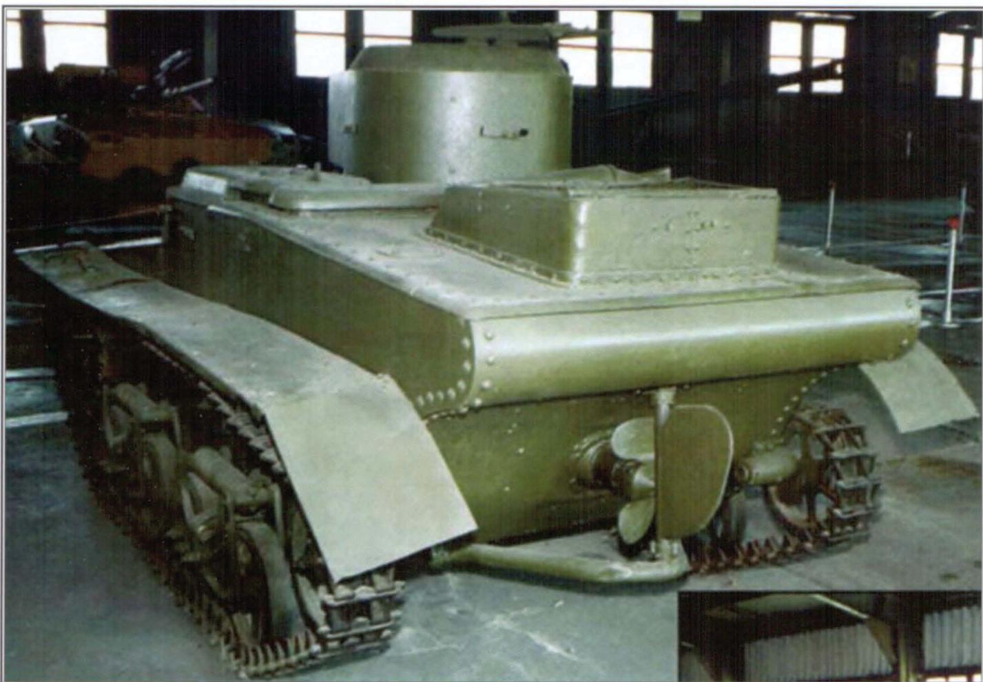
*Легкий плавающий танк Т-37А (1933 год). Его движение на плаву обеспечивал двухлопастный гребной винт; поворот осуществлялся с помощью руля, установленного в потоке винта. Активно использовался в частях и соединениях ОКДВА. Военно-исторический музей бронетанкового вооружения и техники в Кубинке под Москвой*
