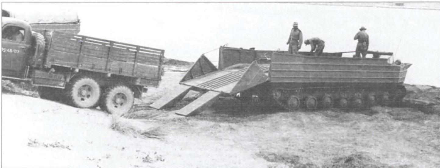
**Погрузка автомашины ЗИС-151 на транспортер задним ходом по откидным аппаратам**
